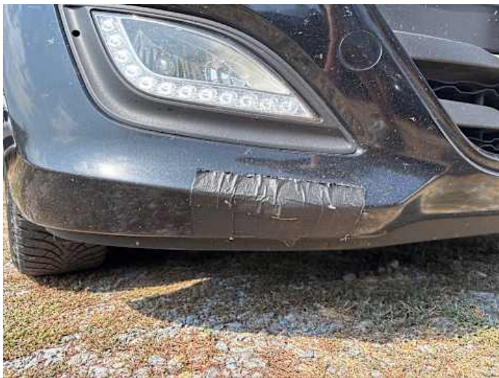
Stoßstange vorne (Unsachgemäß instand gesetzt)
