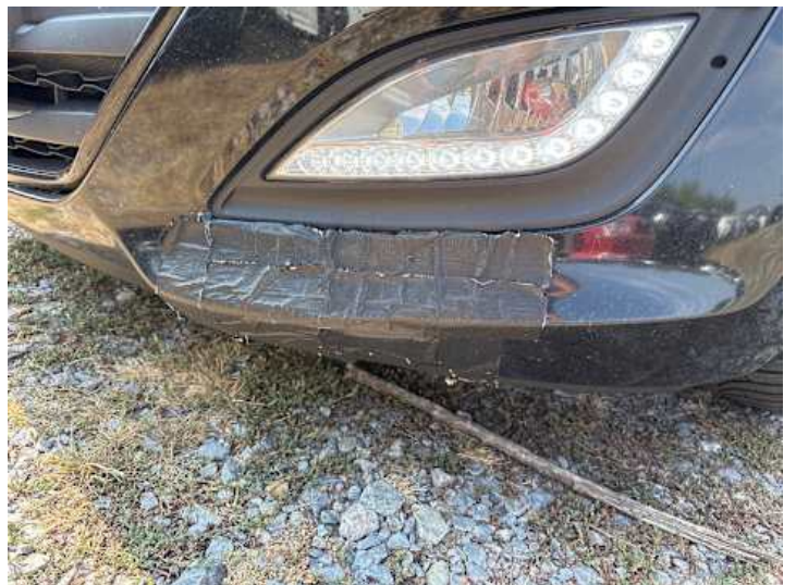
Stoßstange vorne (Unsachgemäß instand gesetzt)
