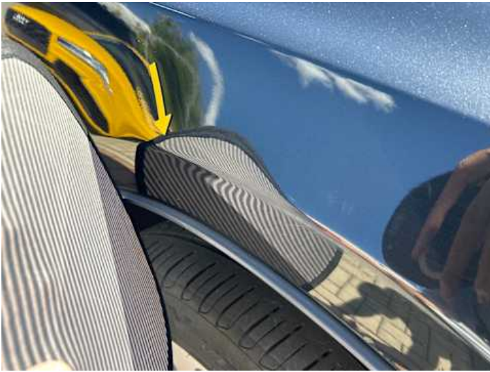
Kotflügel vorne rechts (Kratzer, Verformung, Rost)
