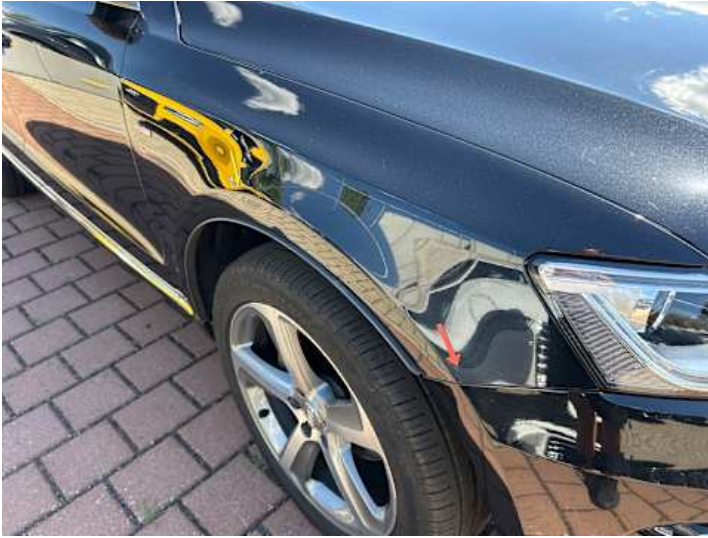
Kotflügel vorne rechts (Kratzer, Verformung, Rost)
