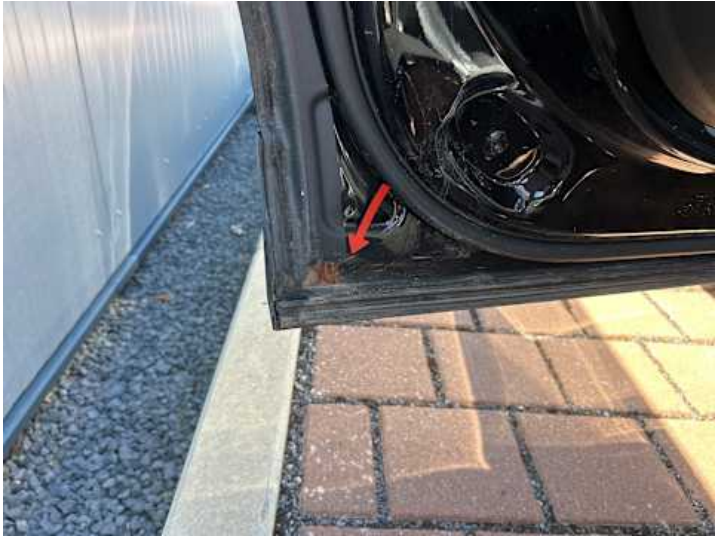
Türe hinten links (Rost)
