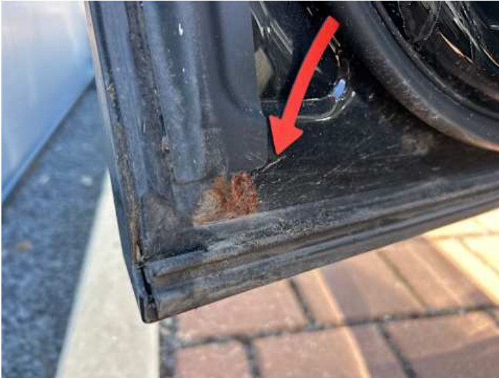
Türe hinten links (Rost)
