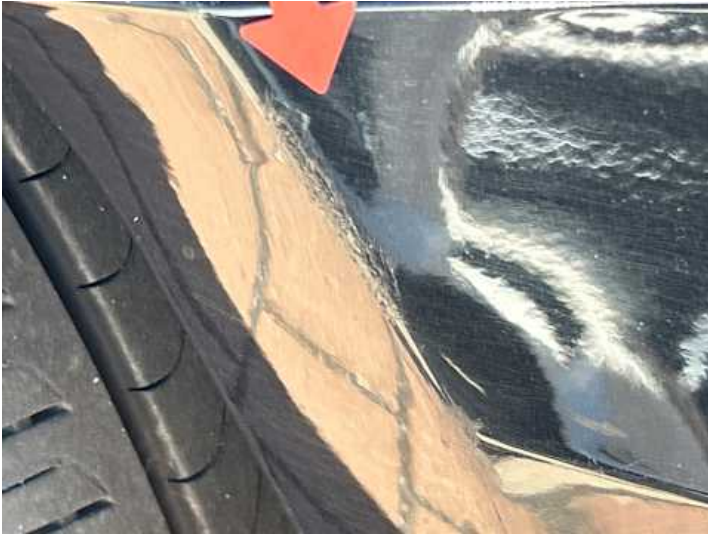
Stoßstange vorne (Kratzer, Unsachgemäß instand gesetzt)
