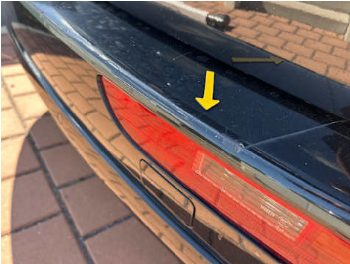
Stoßstange hinten (Verformung, Kratzer)
