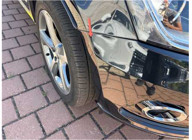
Stoßstange vorne (Kratzer, Unsachgemäß instand gesetzt)
