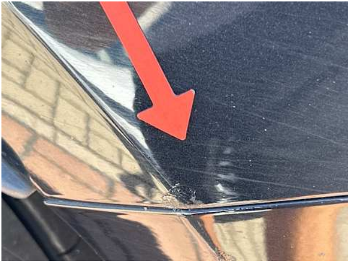
Kotflügel vorne rechts (Kratzer, Verformung, Rost)
