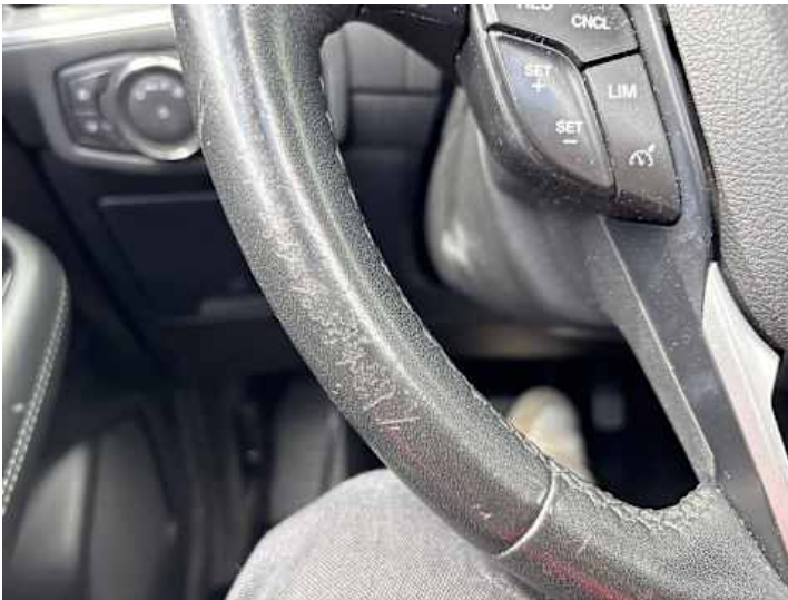
Innenraum (Verschleiß, Kratzer)
