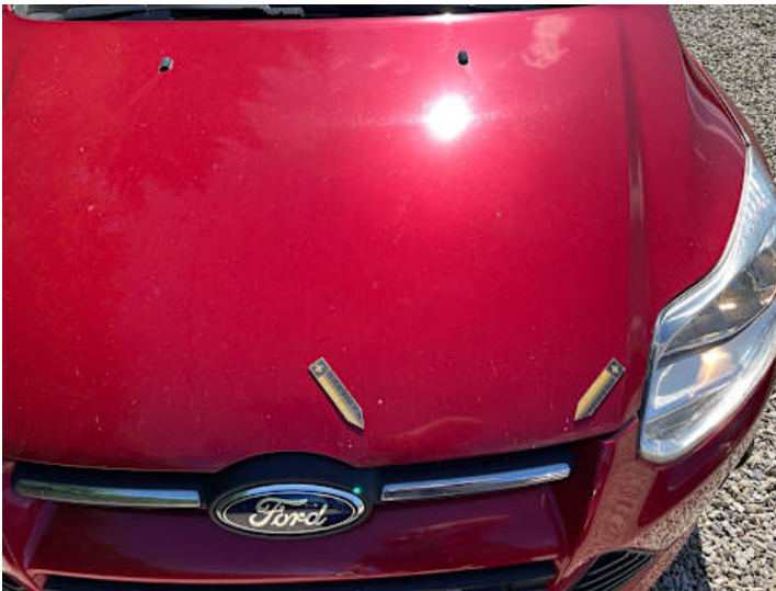
Motorhaube (Lackschaden, Rost, Steinschlag)
