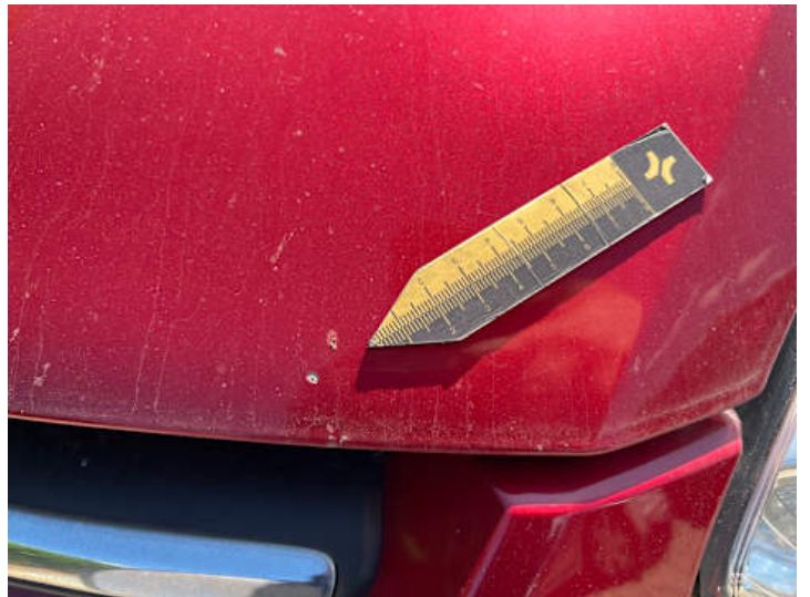
Motorhaube (Lackschaden, Rost, Steinschlag)
