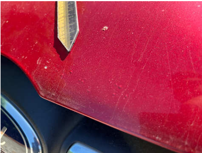
Motorhaube (Lackschaden, Rost, Steinschlag)
