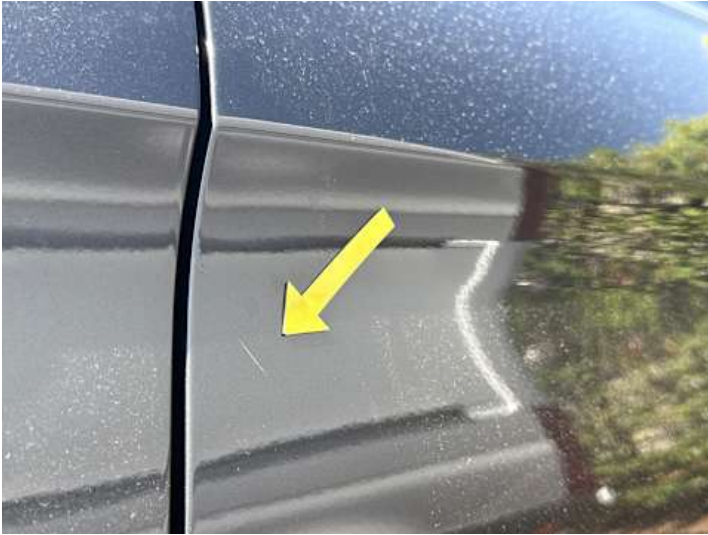
Türe hinten links (Kratzer)
