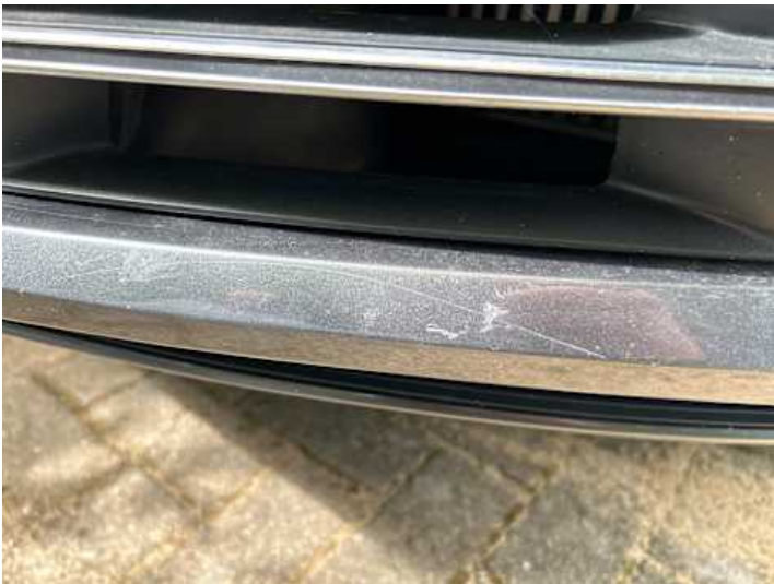
Stoßstange vorne (Spaltmaße ungenau, Kratzer)
