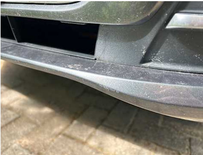
Stoßstange vorne (Spaltmaße ungenau, Kratzer)
