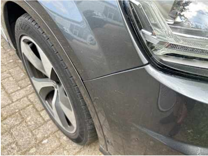
Kotflügel vorne rechts (Spaltmaße ungenau)
