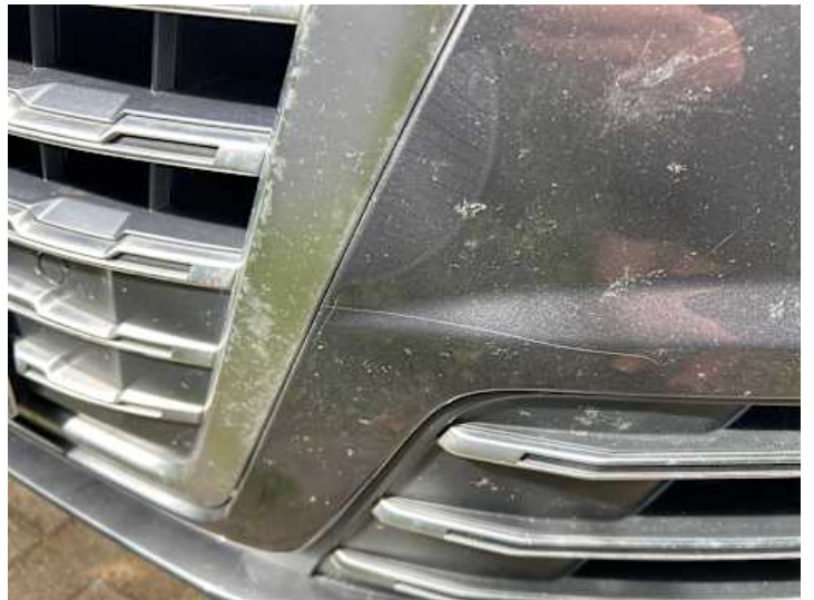
Stoßstange vorne (Spaltmaße ungenau, Kratzer)
