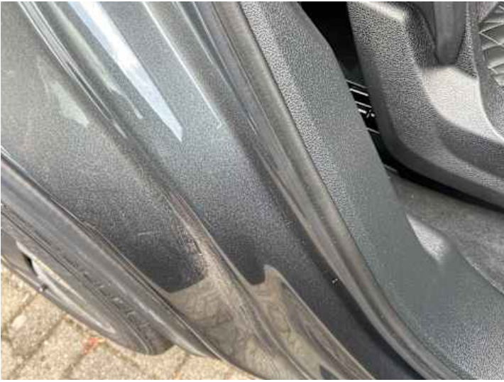
Türe hinten rechts (Delle, Kratzer)
