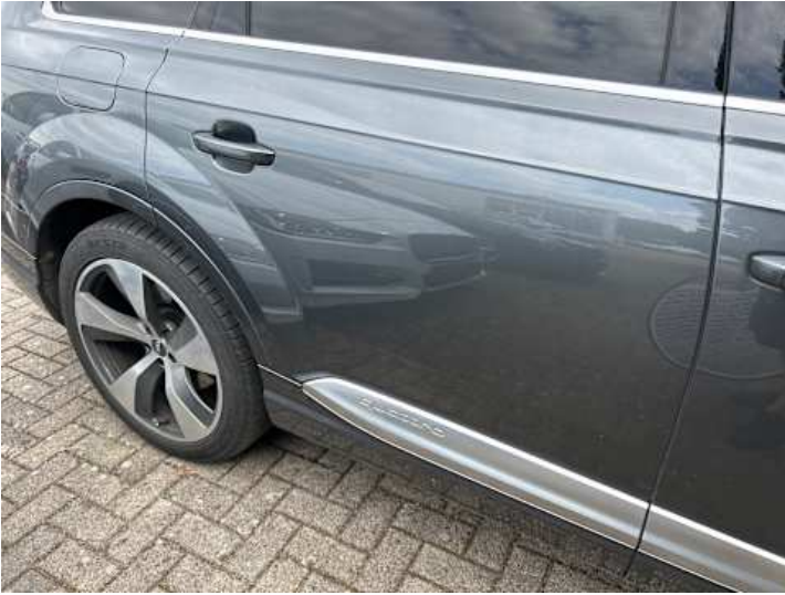
Türe hinten rechts (Delle, Kratzer)
