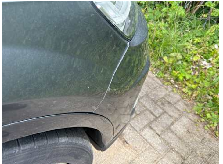
Stoßstange vorne (Spaltmaße ungenau, Kratzer)
