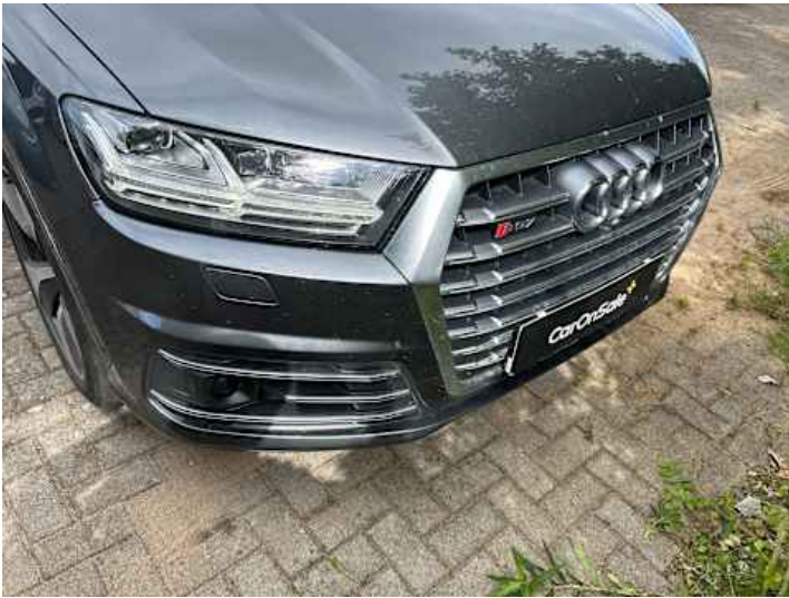
Stoßstange vorne (Spaltmaße ungenau, Kratzer)
