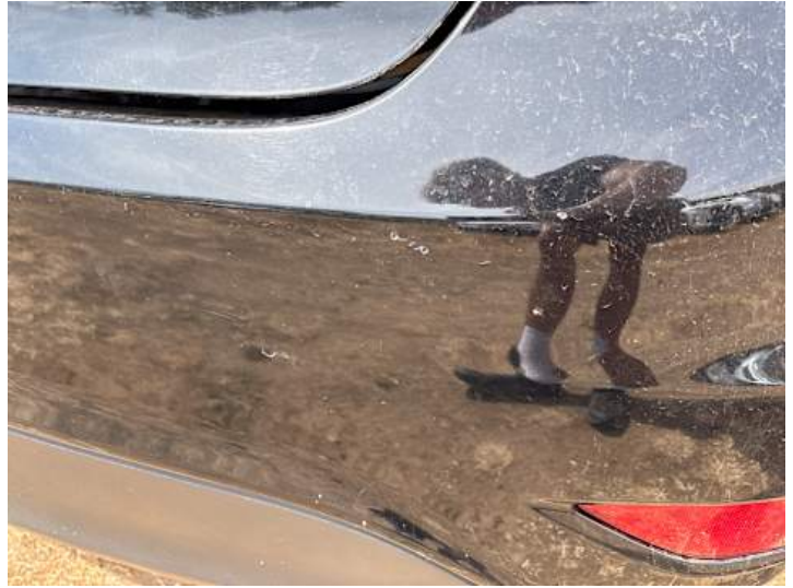
Stoßstange hinten (Kratzer, Spaltmaße ungenau)
