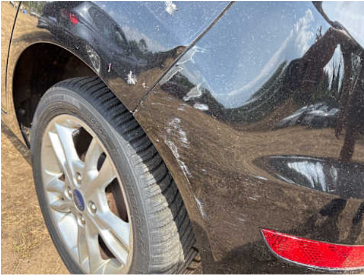
Stoßstange hinten (Kratzer, Spaltmaße ungenau)
