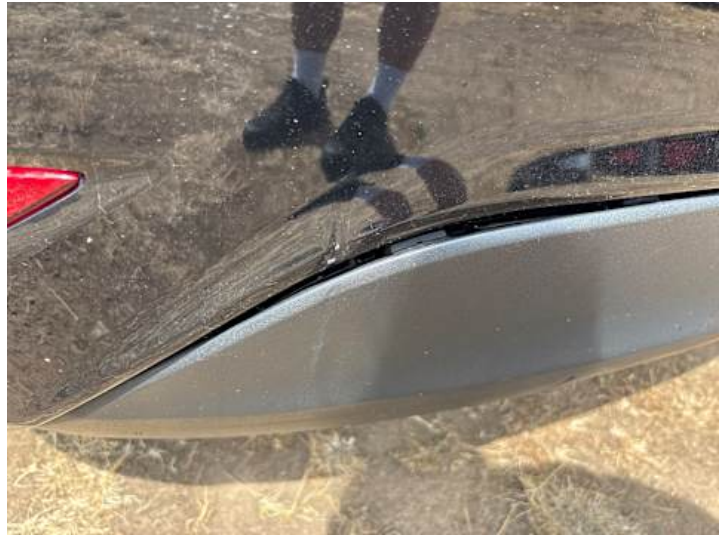
Stoßstange hinten (Kratzer, Spaltmaße ungenau)
