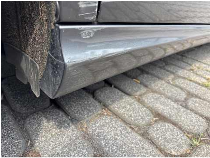
Schweller rechts (Lackschaden)
