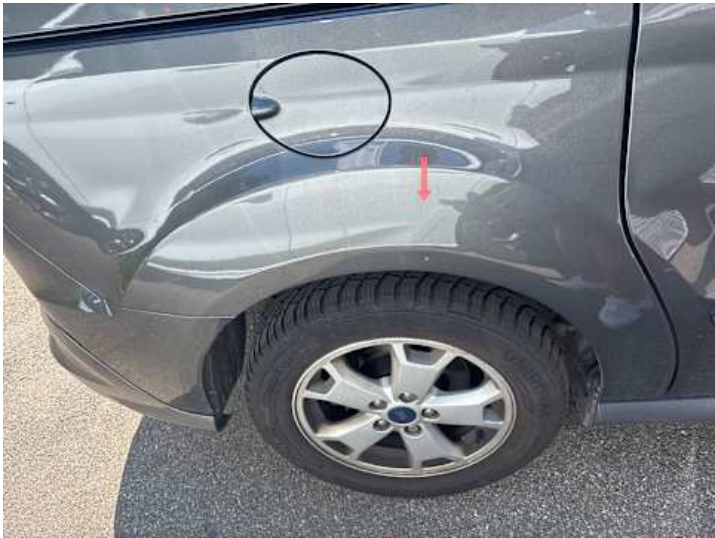
Seitenteil hinten rechts (Delle, Lackschaden)
