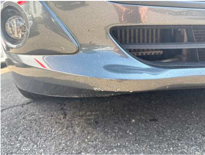
Stoßstange vorne (Spaltmaße ungenau, Kratzer, Lackschaden)
