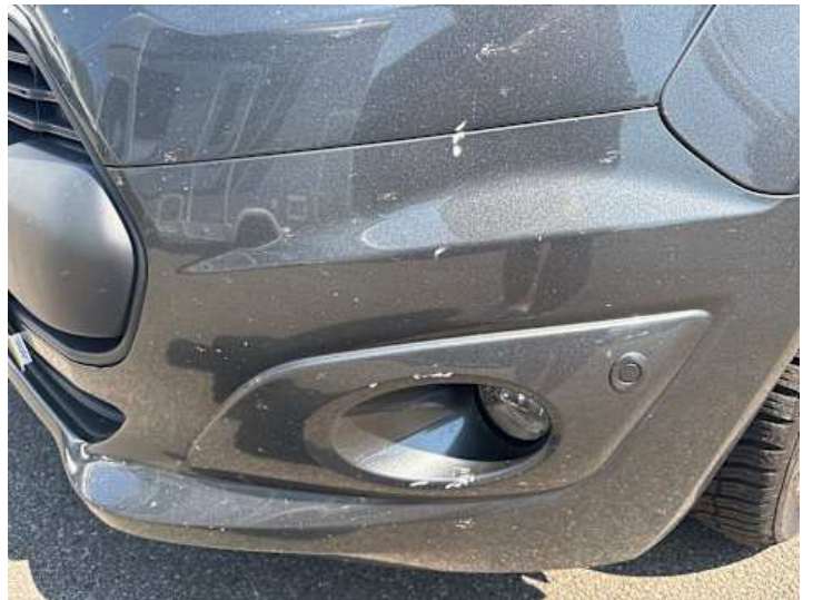
Stoßstange vorne (Spaltmaße ungenau, Kratzer, Lackschaden)
