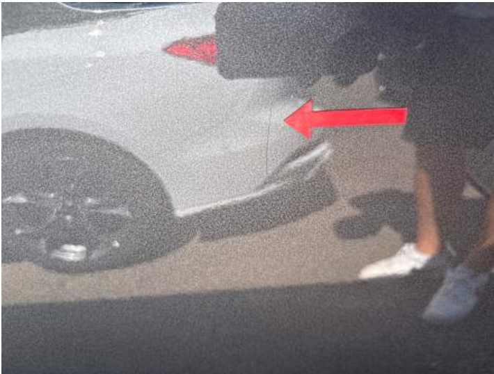
Türe hinten rechts (Kratzer, Lackschaden)
