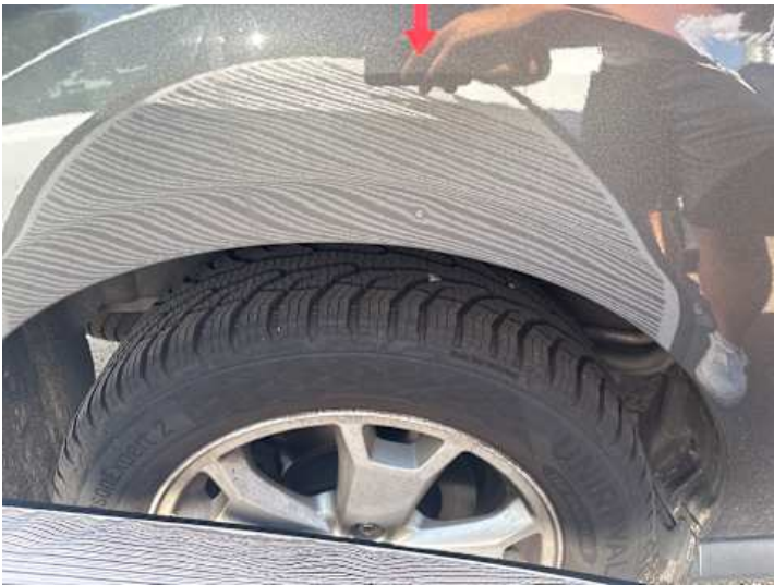
Seitenteil hinten rechts (Delle, Lackschaden)
