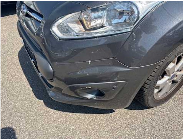
Stoßstange vorne (Spaltmaße ungenau, Kratzer, Lackschaden)
