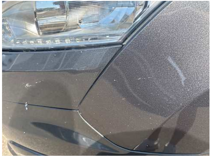
Stoßstange vorne (Spaltmaße ungenau, Kratzer, Lackschaden)
