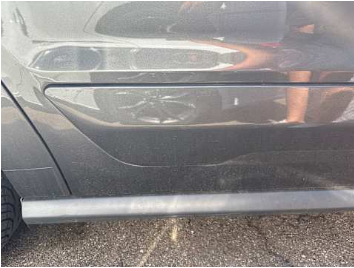
Türe hinten rechts (Kratzer, Lackschaden)
