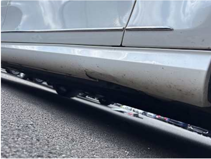
Schweller rechts (Riss/Bruch)
