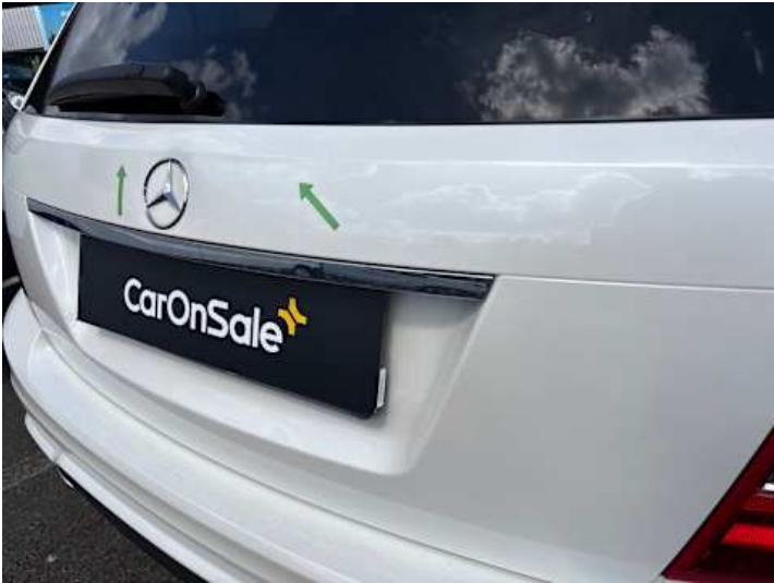
Heckklappe (Kratzer, Delle)
