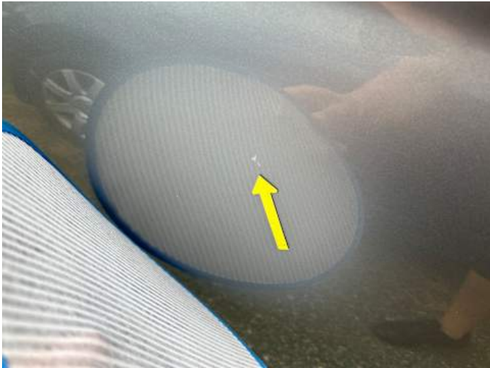
Türe hinten rechts (Delle, Kratzer)
