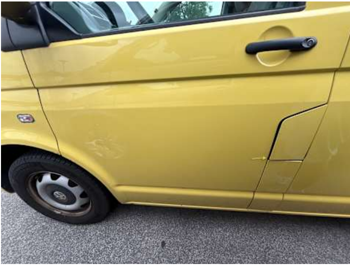
Fahrertür (Rost, Delle)
