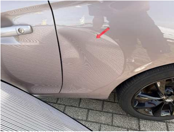
Seitenteil hinten links (Verformung)
