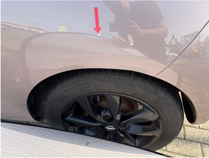
Seitenteil hinten links (Verformung)
