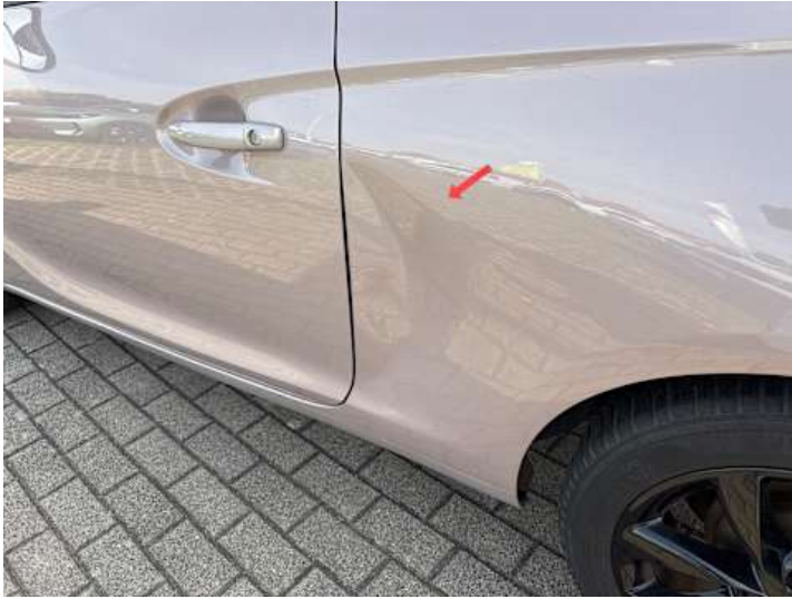
Seitenteil hinten links (Verformung)
