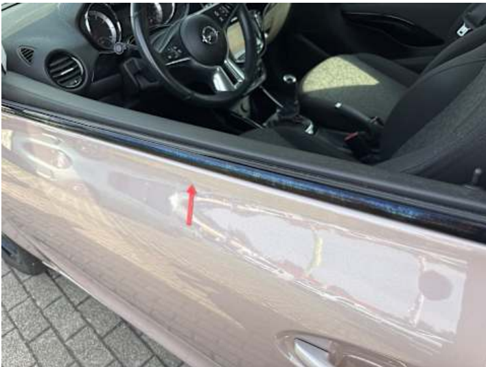
Fahrertür (Anderer Schaden): Leiste verfärbt
