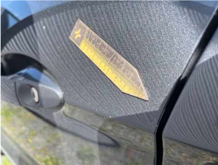
Fahrtür (Kratzer, Delle)
