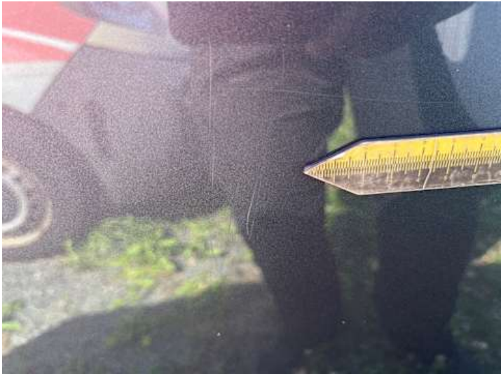
Türe hinten rechts (Kratzer)
