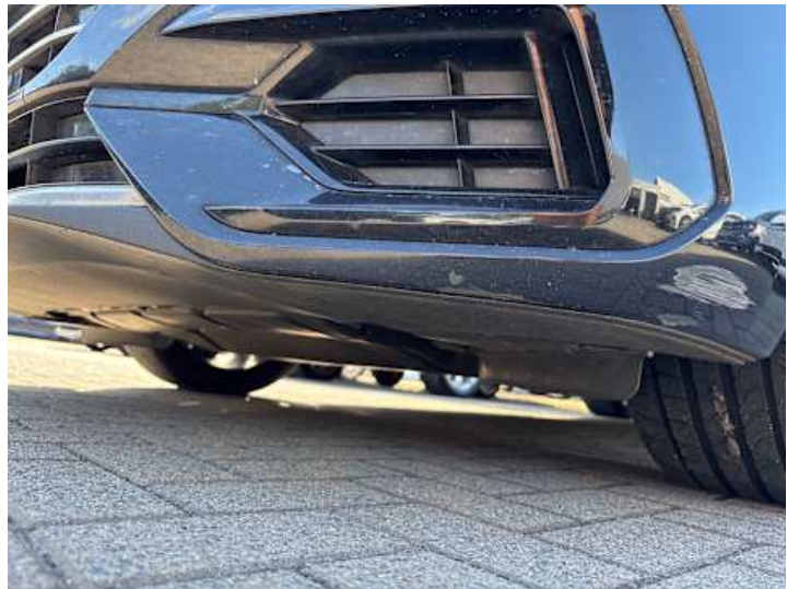
Stoßstange vorne (Kratzer, Lackschaden)
