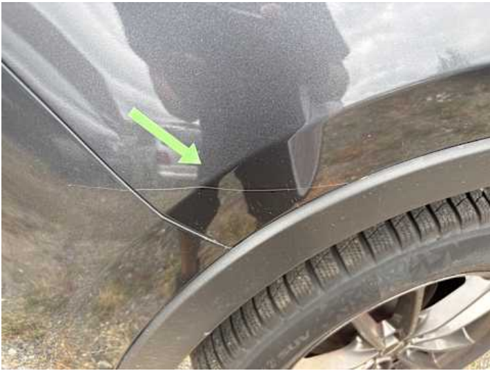
Seitenteil hinten rechts (Kratzer)
