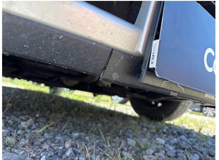
Stoßstange vorne (Riss/Bruch)
