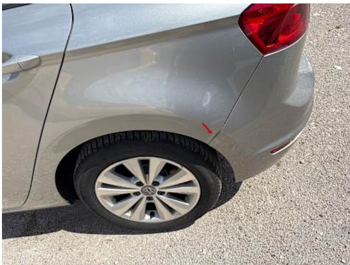
Stoßstange hinten (Spaltmaße ungenau)
