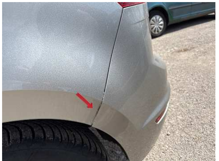
Stoßstange hinten (Spaltmaße ungenau)
