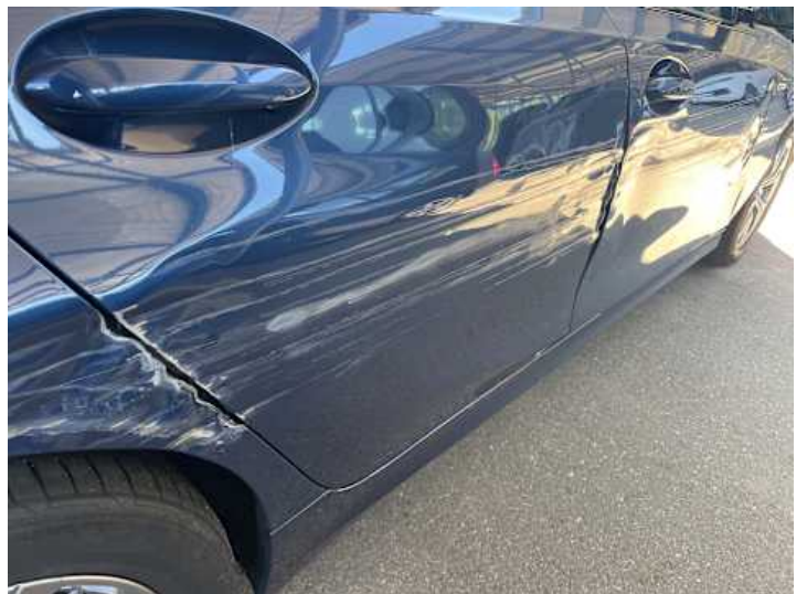
Türe hinten rechts (Lackschaden, Verformung)
