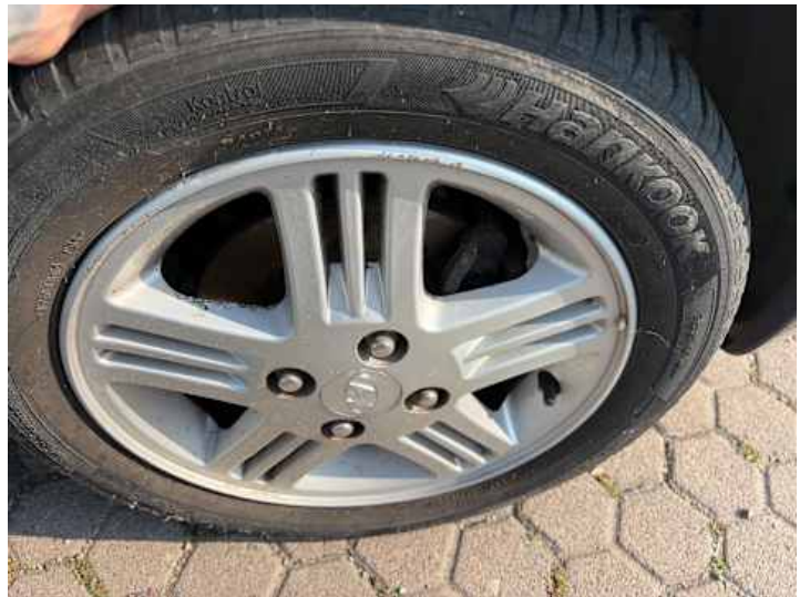
Rad (Kratzer, Kerben, Rost)
