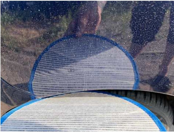
Seitenteil hinten rechts (Delle, Kratzer, Verformung, Lackschaden)
