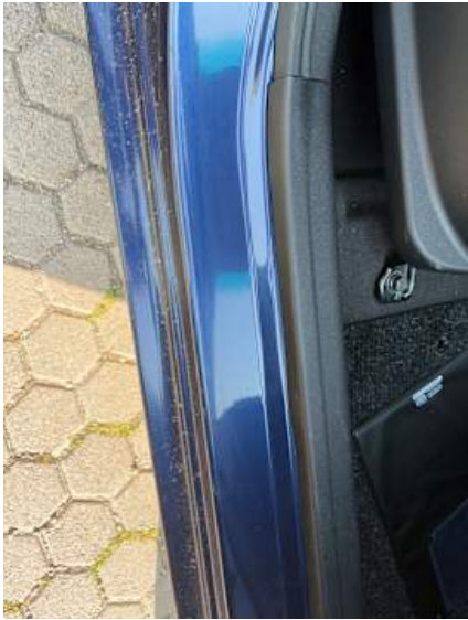
Schweller rechts (Kratzer)
