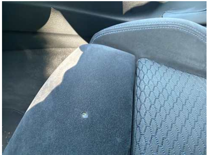
Innenraum (Verschmutzung, Verschleiß, Kratzer, Brandloch)
