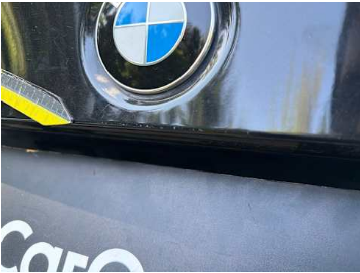
Heckklappe (Rost, Kratzer)
