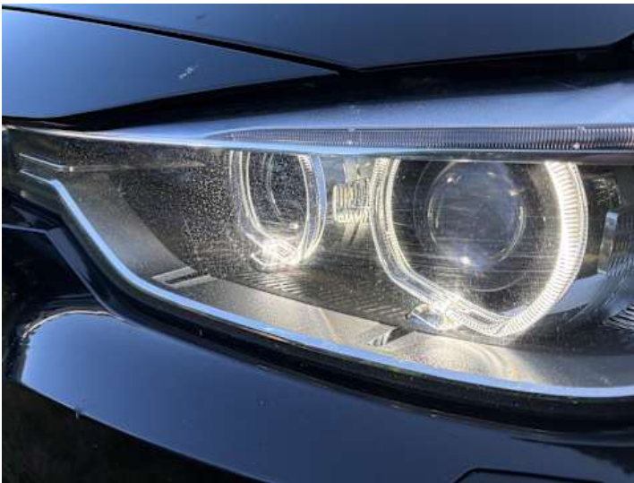
Scheinwerfer (links) (Kratzer, Steinschlag)
