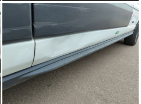
Tür / Rechts / Delle
