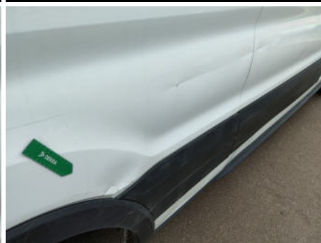
Seitenwand / Hinten Rechts / Delle
