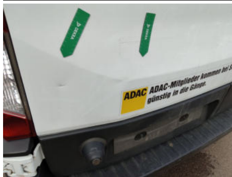
Tür / Hinten Links / Delle
