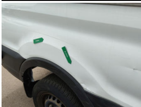
Seitenwand / Hinten Rechts / Delle
