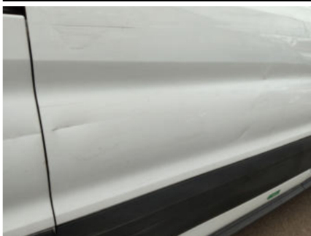
Tür / Rechts / Delle
