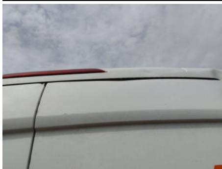
Dach / Hinten / Delle
