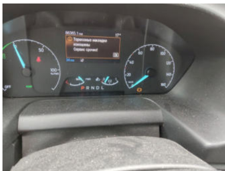
Warnleuchte Bremssystem / Defekt
