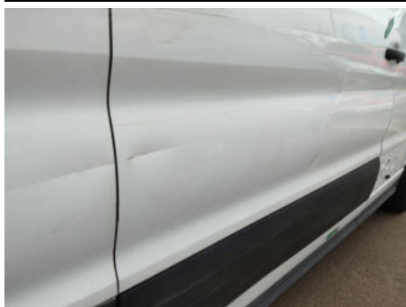
Tür / Rechts / Delle
