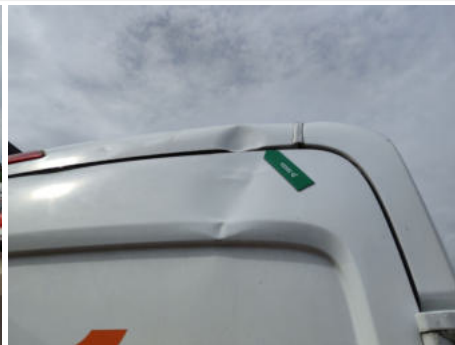
Dach / Hinten / Delle
