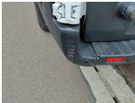
Stoßfänger / Hinten Links / Gebrochen
