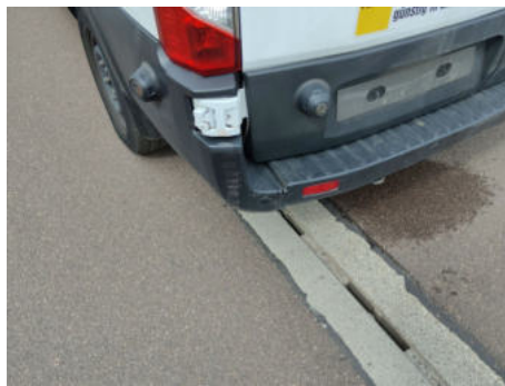
Stoßfänger / Hinten Links / Gebrochen
