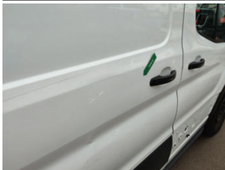
Tür / Rechts / Delle
