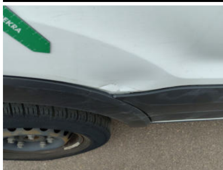
Seitenwand / Hinten Rechts / Delle
