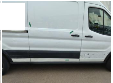
Tür / Rechts / Delle
