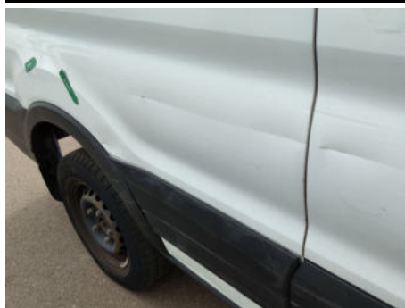
Seitenwand / Hinten Rechts / Delle
