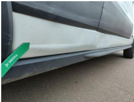
Schweller / Hinten Rechts / Delle
