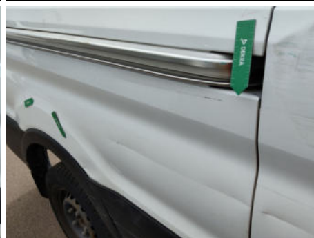
Seitenwand / Hinten Rechts / Delle
