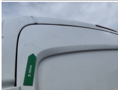
Tür / Hinten Links / Delle
