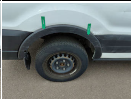
Kotflügelverbreiterung / Hinten Rechts / Gebrochen
