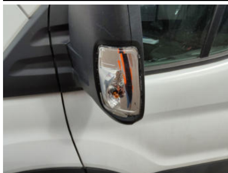
Blinker / Links / Gebrochen
