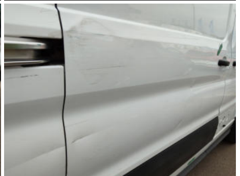
Tür / Rechts / Delle
