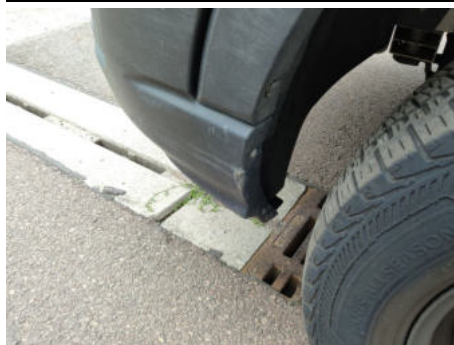
Stoßfänger / Vorne / Gebrochen
