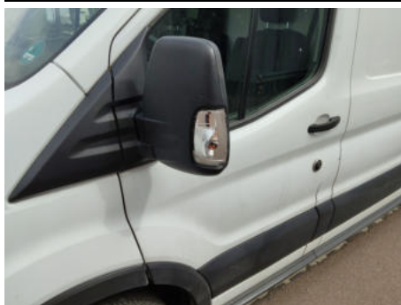
Blinker / Links / Gebrochen
