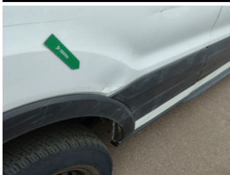
Seitenwand / Hinten Rechts / Delle
