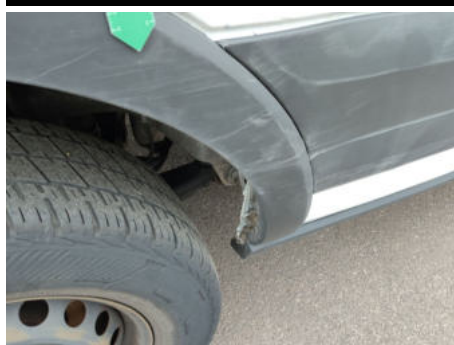
Kotflügelverbreiterung / Hinten Rechts / Gebrochen
