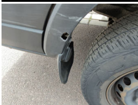
Kotflügelverbreiterung / Hinten Rechts / Gebrochen
