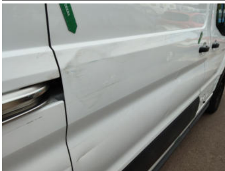
Tür / Rechts / Delle
