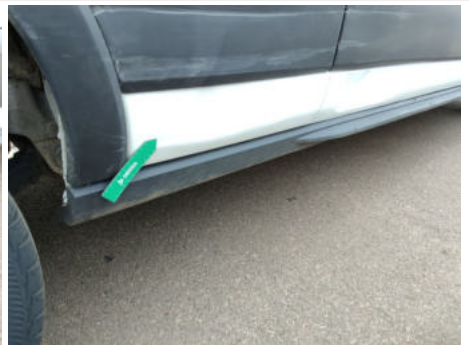
Schweller / Hinten Rechts / Delle
