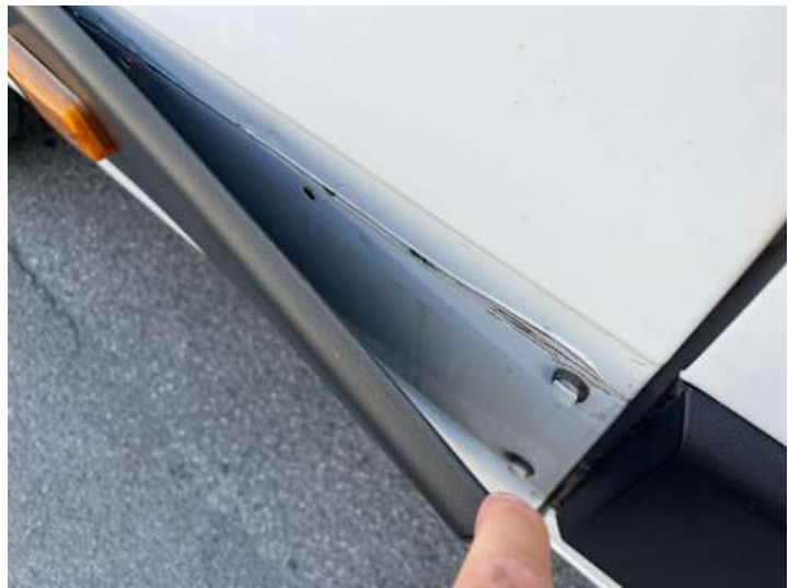
Seitenteil hinten rechts (Riss/Bruch)
