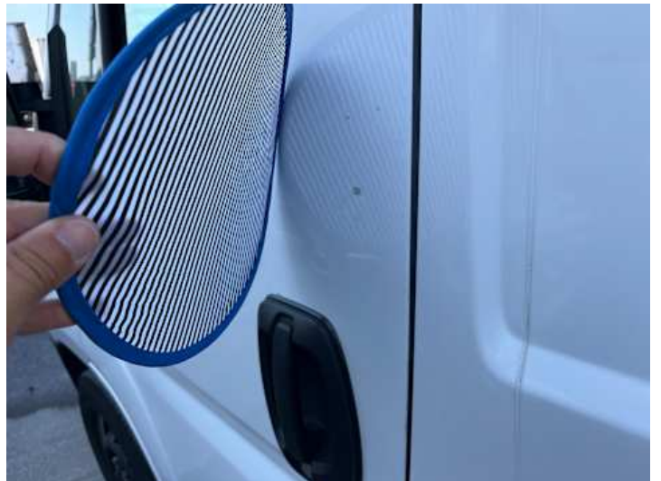
Fahrtür (Delle, Kratzer)
