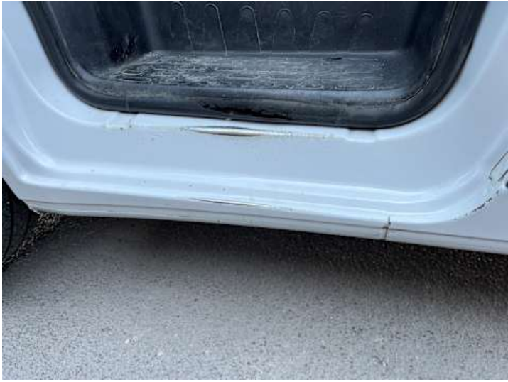
Schweller links (Lackschaden)
