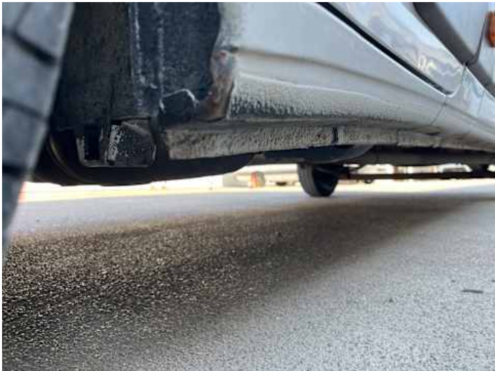
Schweller links (Rost)
