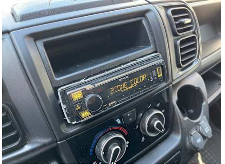
Innenraum (Anderer Schaden): Radioeinbau mangelhaft
