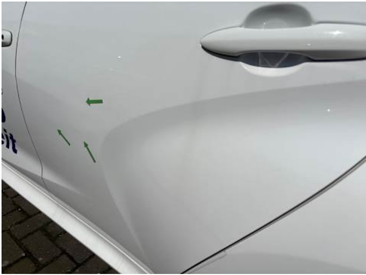
Türe hinten links (Delle)
