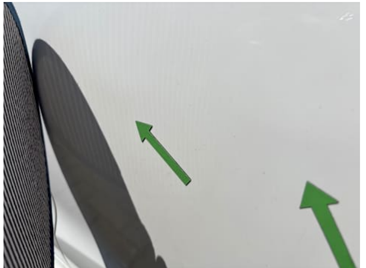
Türe hinten links (Delle)
