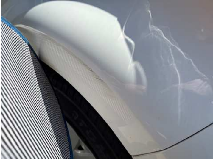
Kotflügel vorne rechts (Kratzer, Delle)
