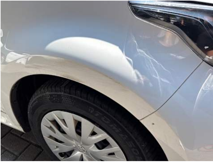
Kotflügel vorne rechts (Kratzer, Delle)
