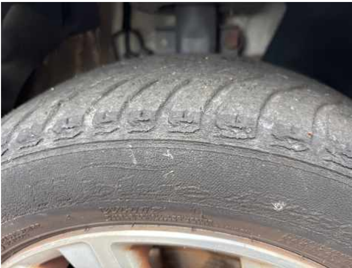
Rad (vehicle.damage-label.porous, Kratzer, Kerben)
