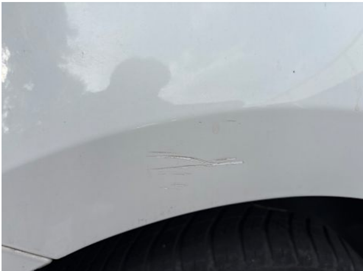
Seitenteil hinten rechts (Kratzer)
