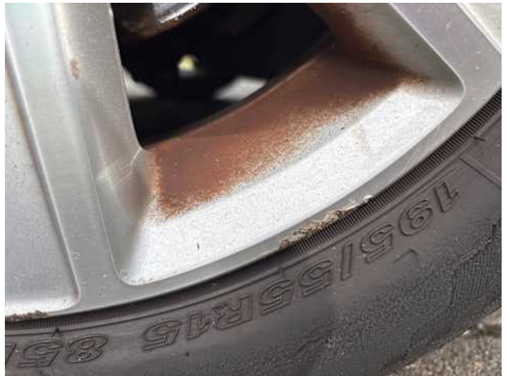
Rad (vehicle.damage-label.porous, Kratzer, Kerben)
