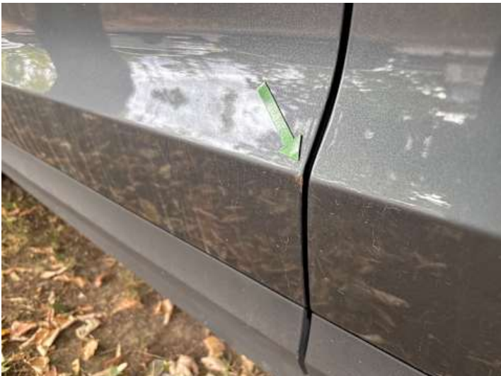
Fahrtür (Kratzer, Rost)
