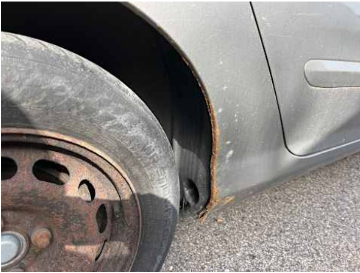
Seitenteil hinten rechts (Rost, Kratzer)
