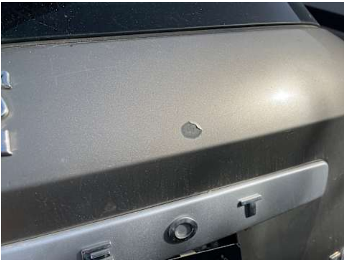
Heckklappe (Rost, Kratzer)
