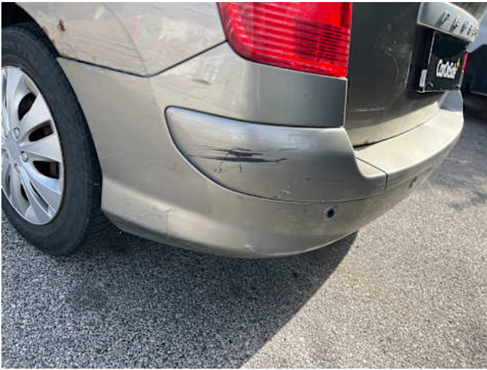
Stoßstange hinten (Delle, Kratzer, Riss/Bruch, Spaltmaße ungenau)
