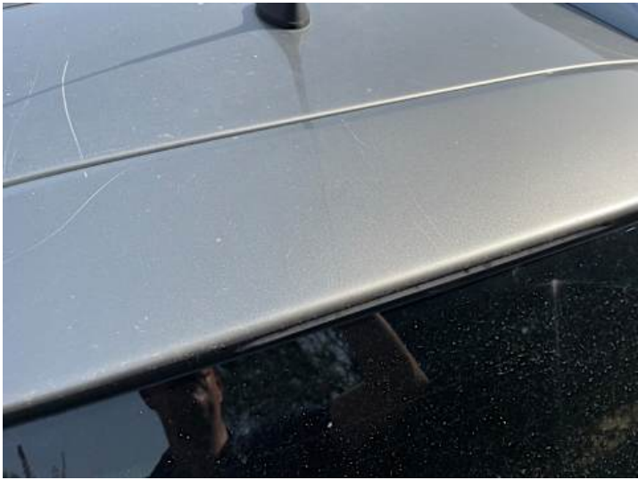
Heckklappe (Rost, Kratzer)
