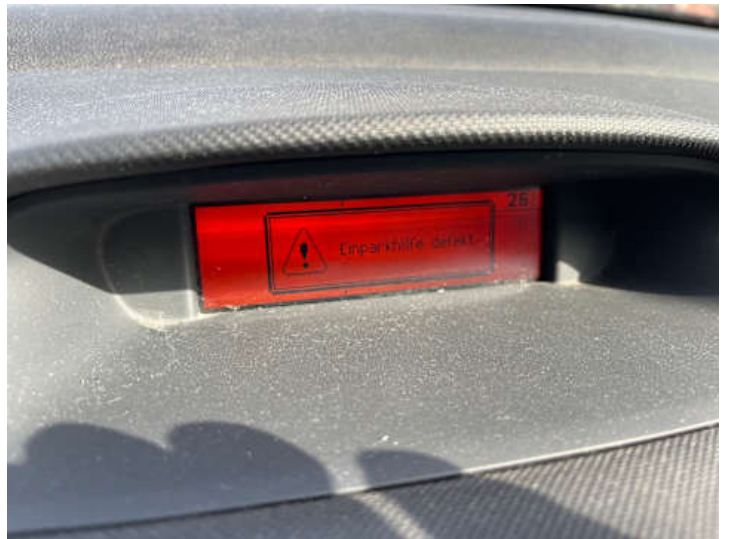
Innenraum (Anderer Schaden): PDC-Fehler
