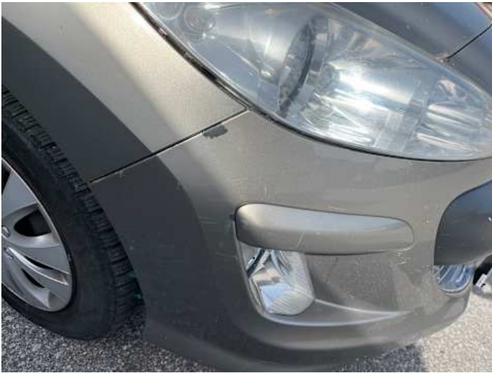
Stoßstange vorne (Riss/Bruch, Lackschaden)
