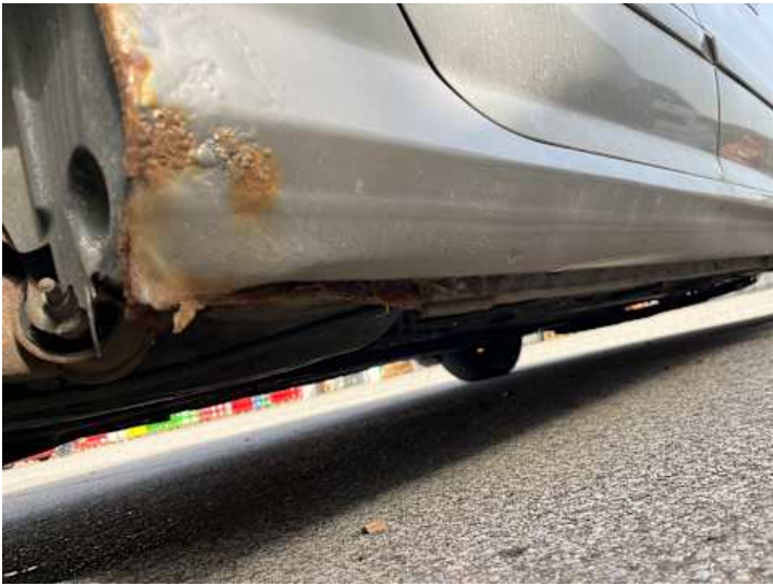
Schweller rechts (Rost)
