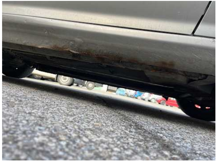
Schweller rechts (Rost)
