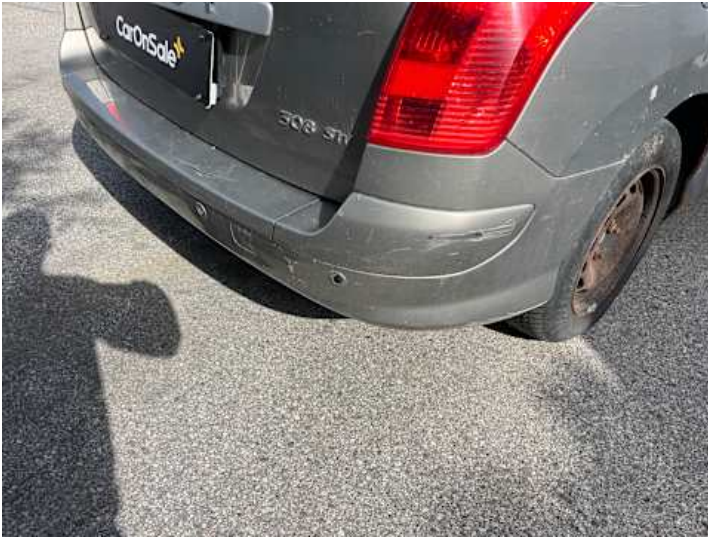
Stoßstange hinten (Delle, Kratzer, Riss/Bruch, Spaltmaße ungenau)
