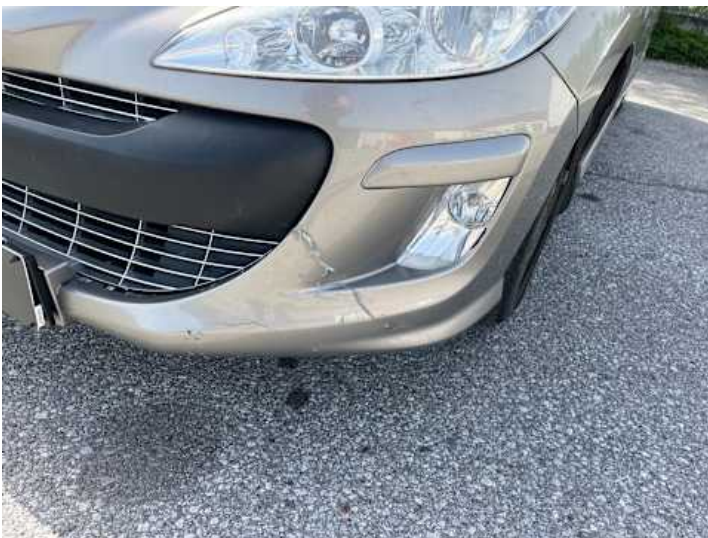
Stoßstange vorne (Riss/Bruch, Lackschaden)
