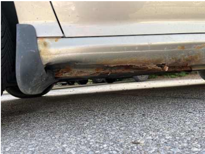
Schweller links (Rost)
