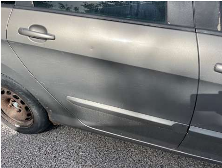
Türe hinten rechts (Delle, Kratzer)
