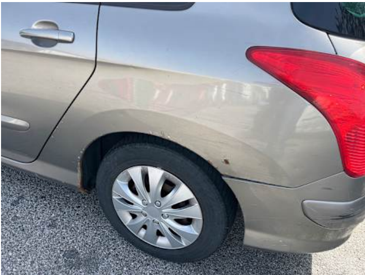
Seitenteil hinten links (Rost, Kratzer)
