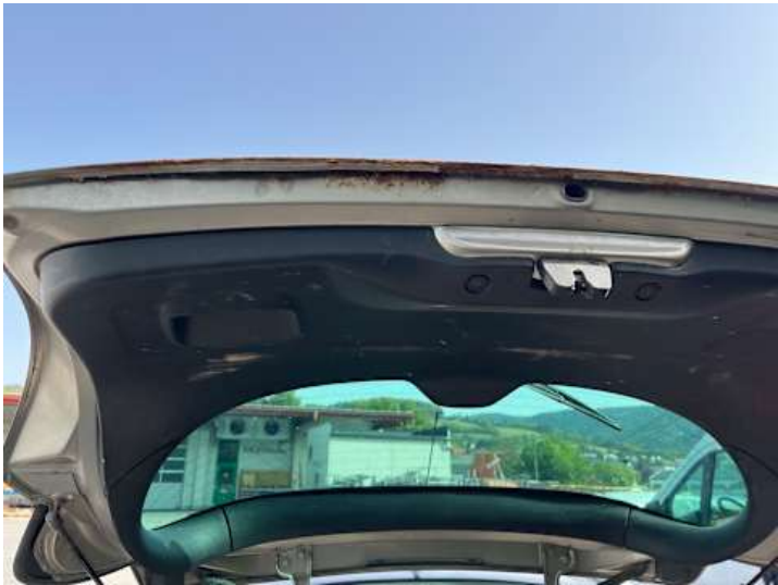
Heckklappe (Rost, Kratzer)
