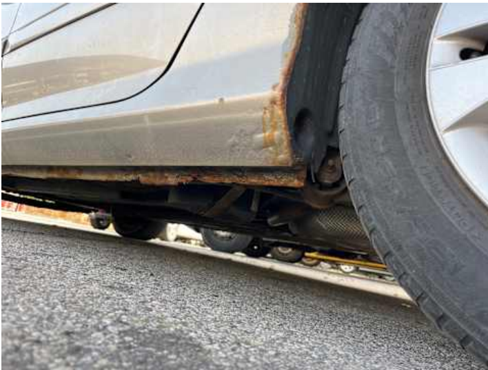
Schweller links (Rost)
