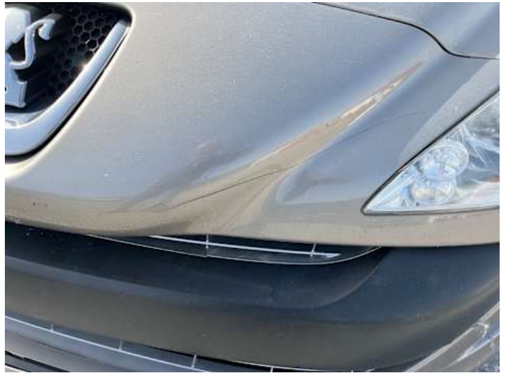
Stoßstange vorne (Riss/Bruch, Lackschaden)
