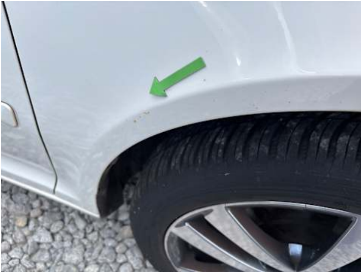
Kotflügel vorne rechts (Rost)
