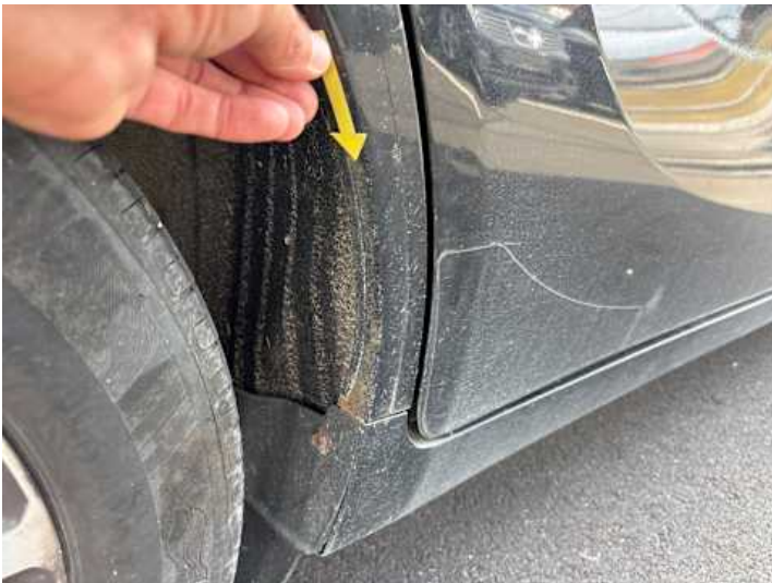
Seitenteil hinten rechts (Delle, Rost)
