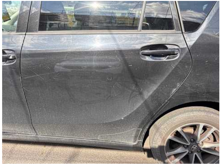
Türe hinten links (Delle, Kratzer)
