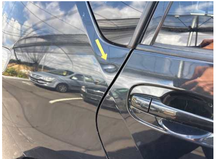
Seitenteil hinten rechts (Delle, Rost)
