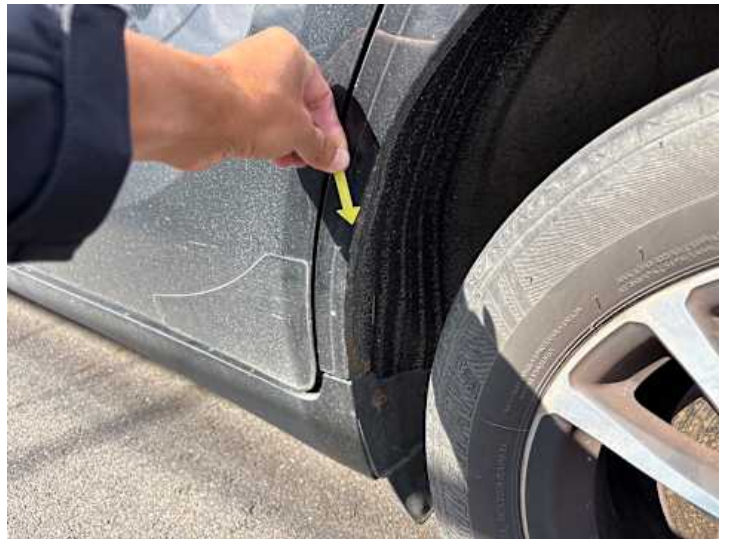
Seitenteil hinten links (Rost, Kratzer)
