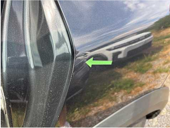
Seitenteil hinten links (Kratzer)
