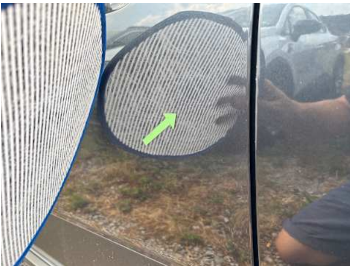
Fahrtür (Unsachgemäß instand gesetzt)
