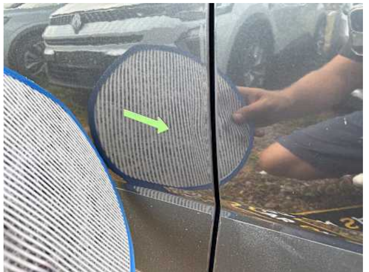
Fahrtür (Unsachgemäß instand gesetzt)
