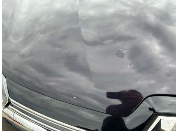
Motorhaube (Lackschaden, Kratzer, Steinschlag)
