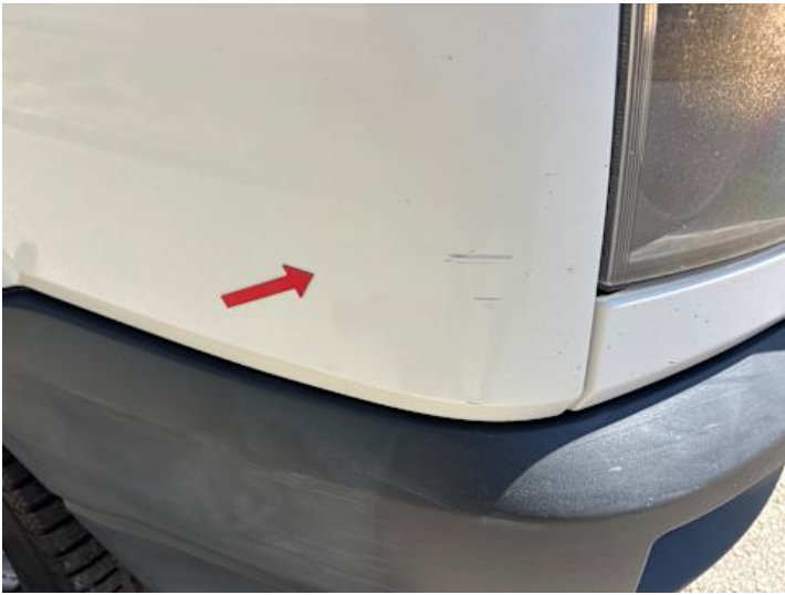
Kotflügel vorne rechts (Delle, Kratzer)
