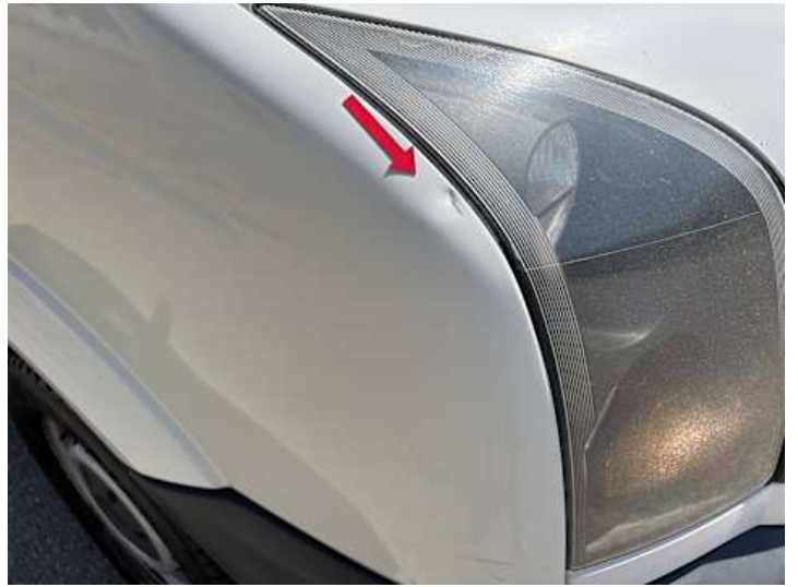
Kotflügel vorne rechts (Delle, Kratzer)
