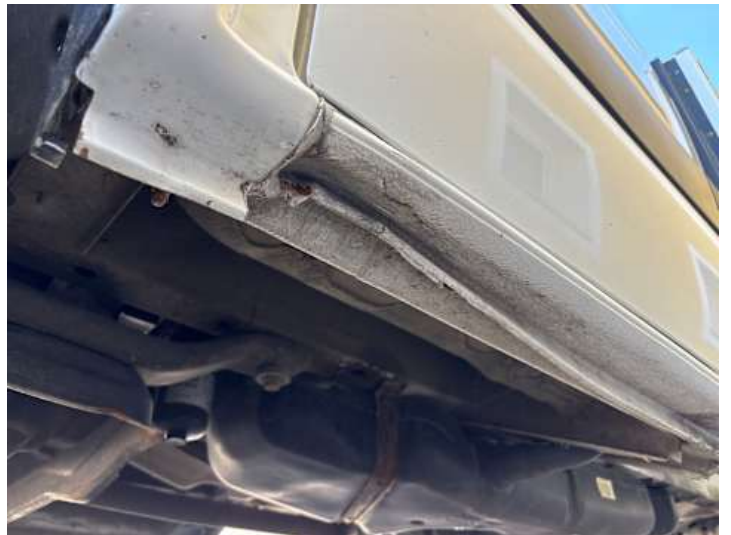
Schweller links (Verformung)
