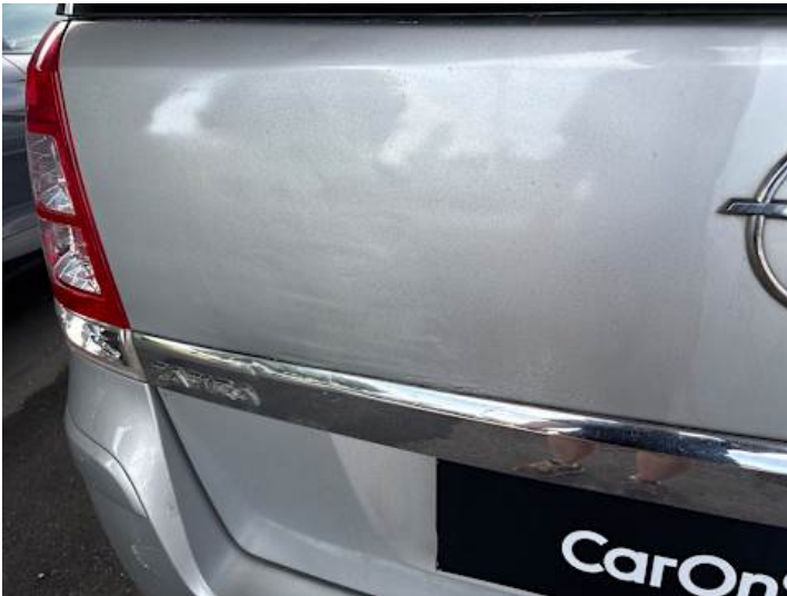
Heckklappe (Verformung, Lackschaden, Unsachgemäß instand gesetzt)
