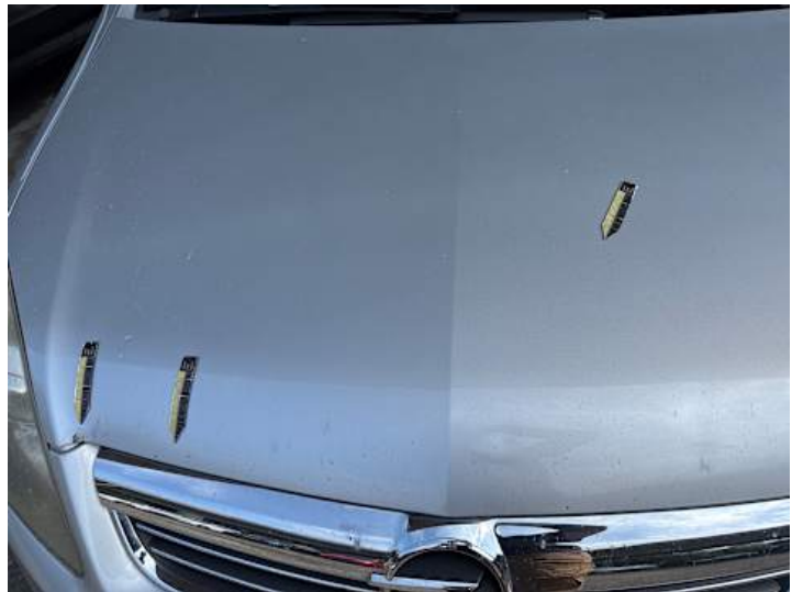
Motorhaube (Lackschaden, Rost, Unsachgemäß instand gesetzt)
