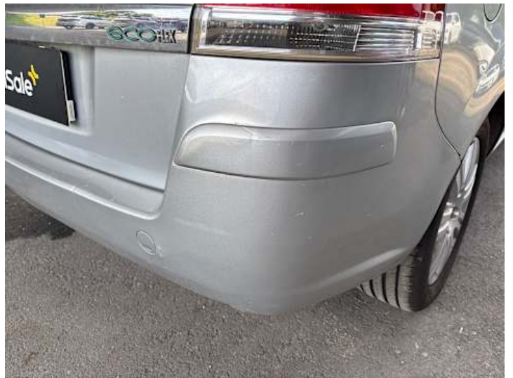
Stoßstange hinten (Kratzer, Riss/Bruch)
