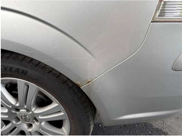
Seitenteil hinten links (Rost)
