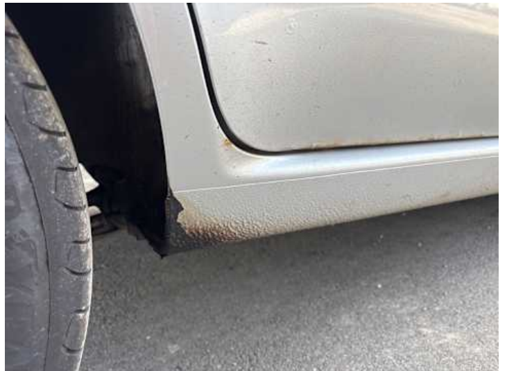
Schweller rechts (Rost, Lackschaden)
