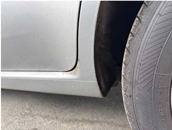
Schweller links (Rost)
