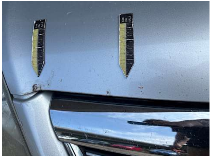
Motorhaube (Lackschaden, Rost, Unsachgemäß instand gesetzt)
