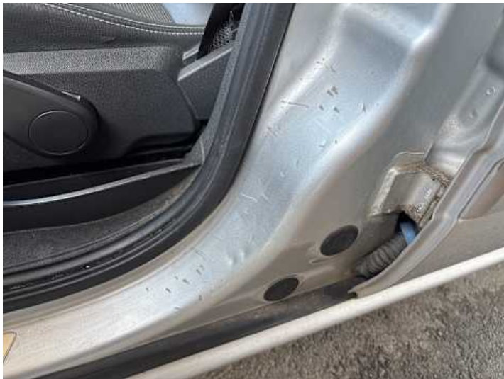
Schweller links (Delle, Kratzer)
