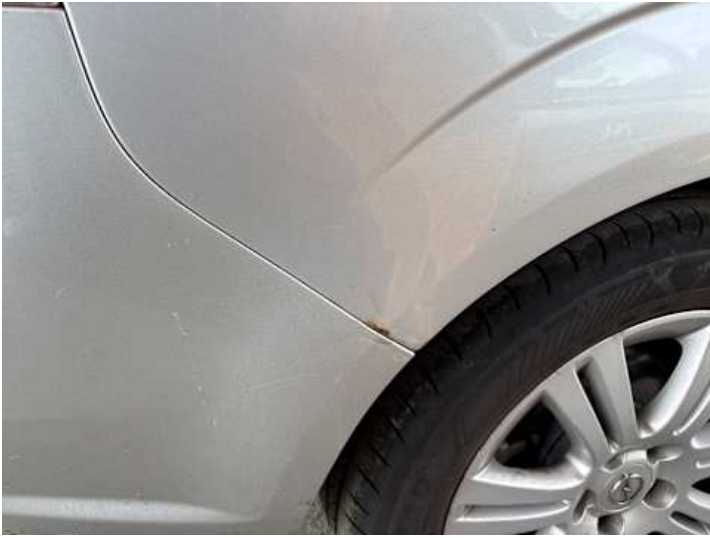
Seitenteil hinten rechts (Rost)
