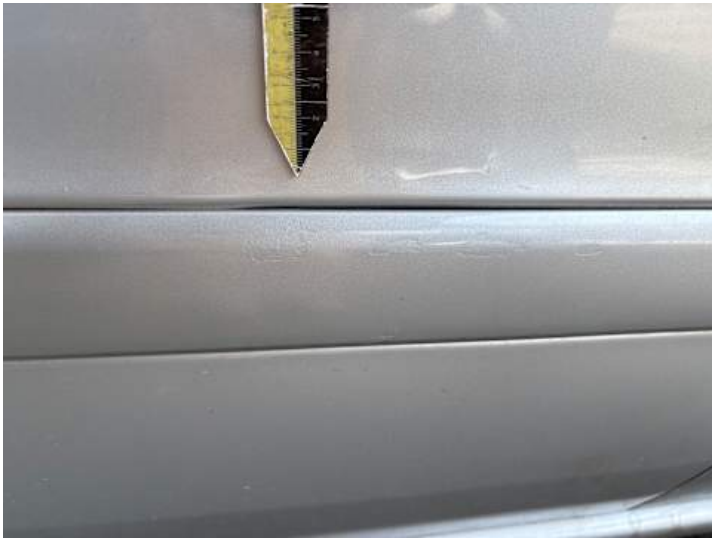
Türe hinten rechts (Verformung, Lackschaden, Delle)
