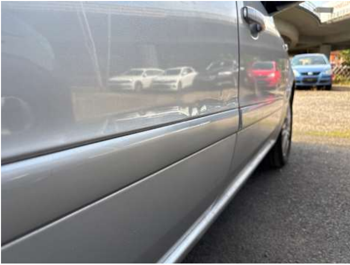
Türe hinten rechts (Verformung, Lackschaden, Delle)
