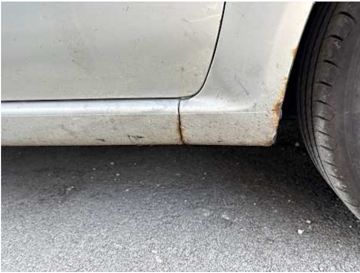
Schweller rechts (Rost, Lackschaden)
