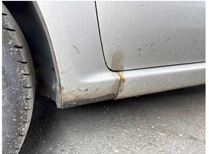
Schweller links (Rost)
