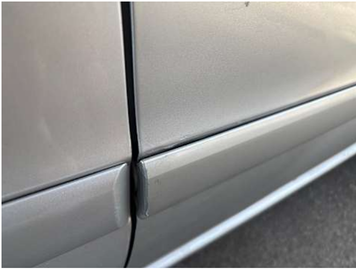
Beifahrertür (Unsachgemäß instand gesetzt)
