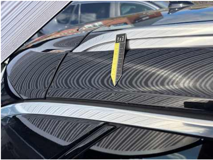
Dach (Steinschlag, Delle)
