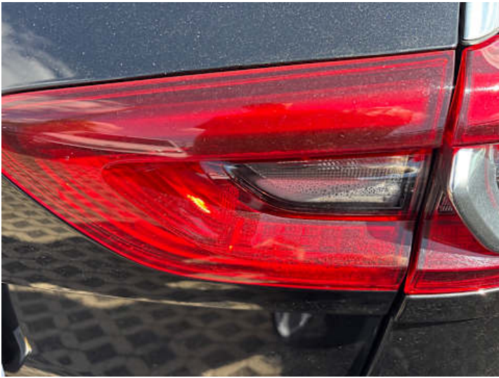
Rücklicht (rechts) (Undicht)
