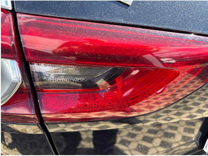
Rücklicht (links) (Undicht)
