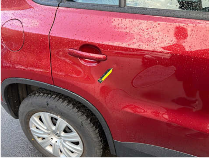
Türe hinten rechts (Delle)
