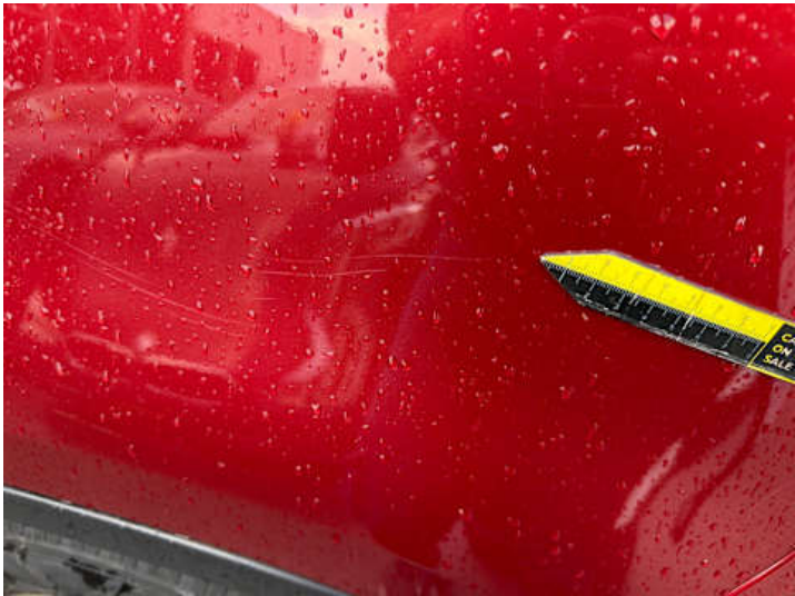
Seitenteil hinten links (Kratzer)
