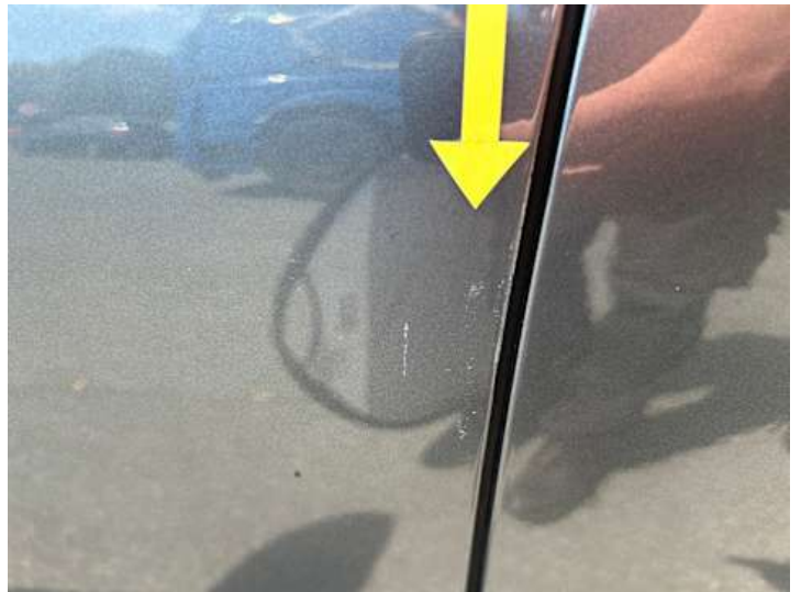
Fahrtür (Kratzer, Lackschaden)
