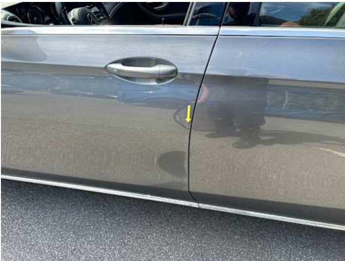
Fahrtür (Kratzer, Lackschaden)
