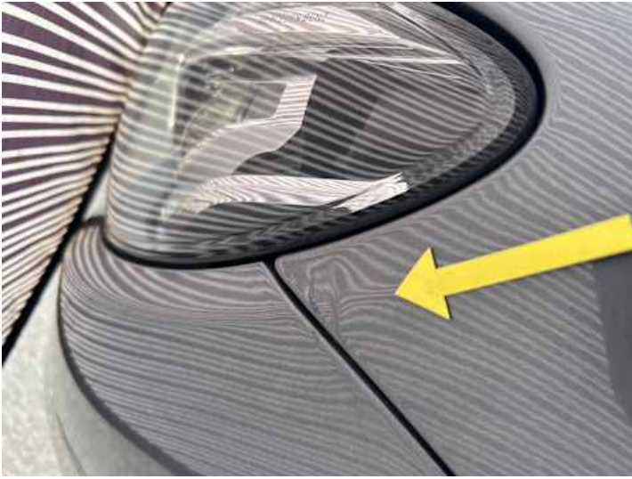
Kotflügel vorne links (Lackschaden, Verformung)
