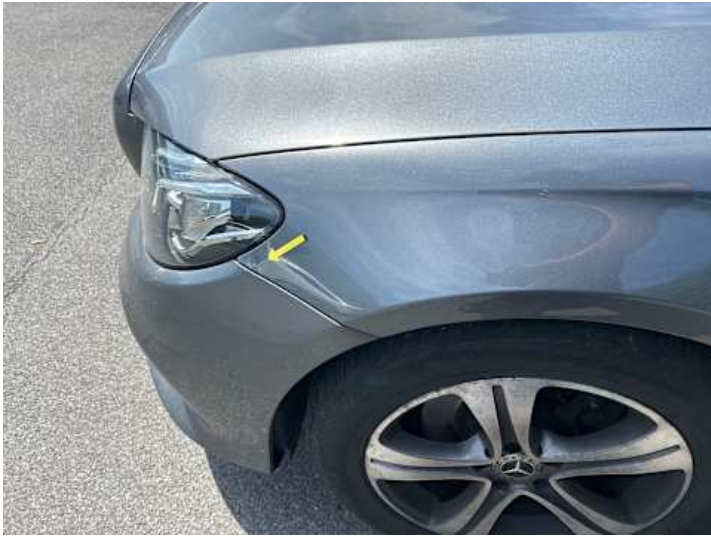
Kotflügel vorne links (Lackschaden, Verformung)
