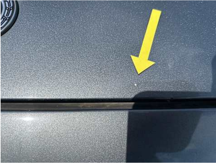
Motorhaube (Lackschaden, Steinschlag)
