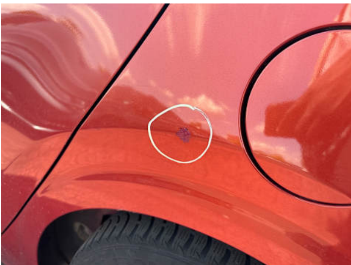
Seitenteil hinten links (Unsachgemäß instand gesetzt)
