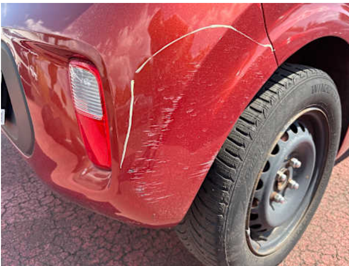
Stoßstange hinten (Kratzer)
