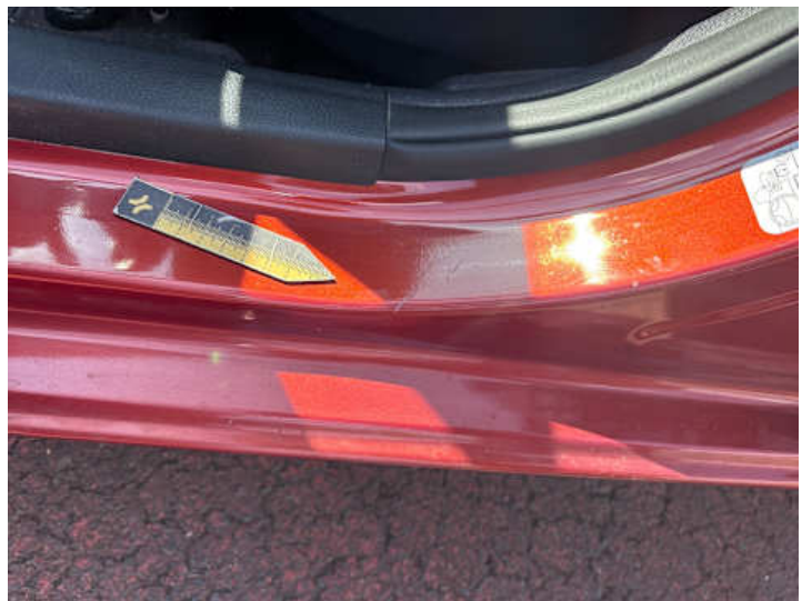
Schweller links (Kratzer)
