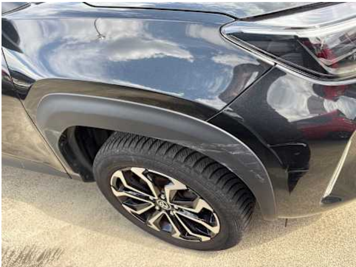
Kotflügel vorne rechts (Kratzer)
