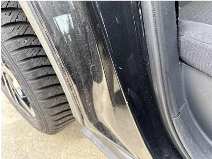
Seitenteil hinten rechts (Kratzer, Delle)
