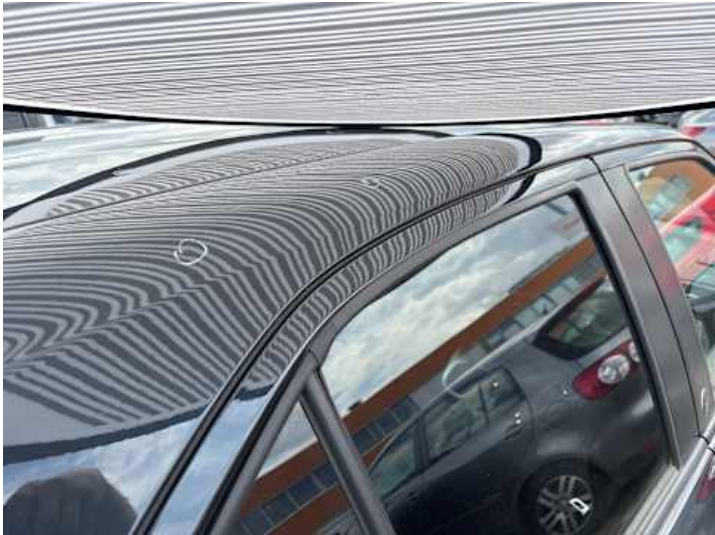
Seitenteil hinten rechts (Delle)
