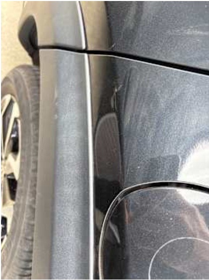
Seitenteil hinten links (Kratzer)
