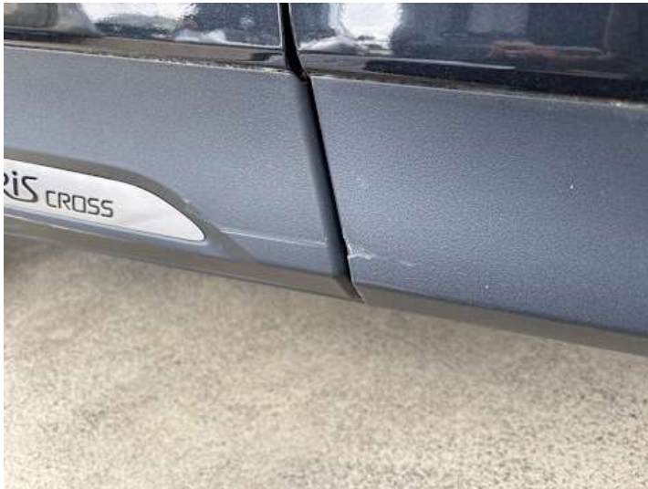
Türe hinten rechts (Delle, Kratzer, Rost)
