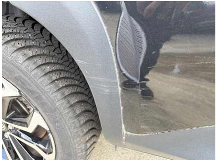
Türe hinten rechts (Kratzer)
