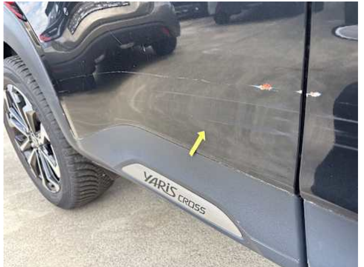
Türe hinten rechts (Delle, Kratzer, Rost)
