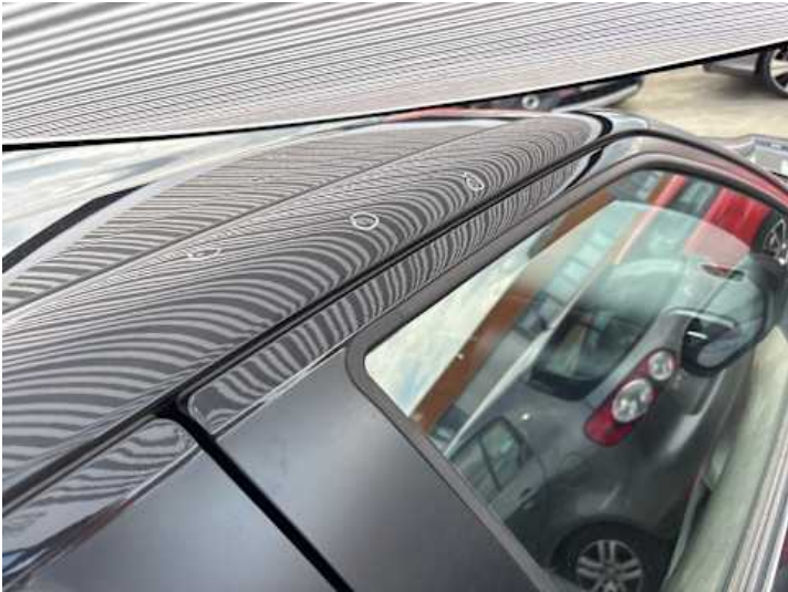
Seitenteil hinten rechts (Delle)
