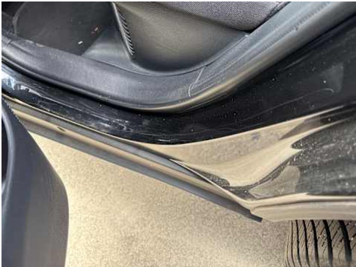
Seitenteil hinten links (Kratzer)
