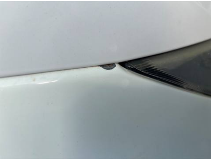
Kotflügel vorne rechts (Lackschaden)
