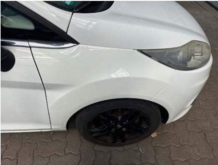
Kotflügel vorne rechts (Unsachgemäß instand gesetzt)
