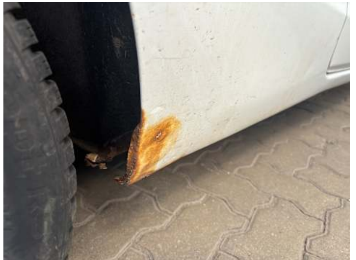
Schweller rechts (Rost)
