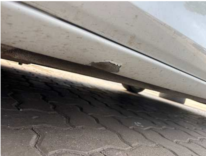
Schweller links (Rost, Lackschaden)
