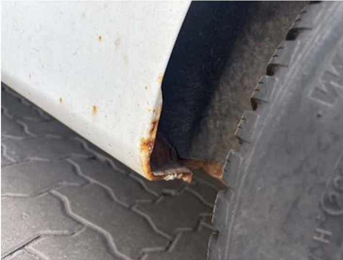
Seitenteil hinten links (Rost)
