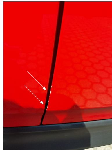
Bild 2: Außen, Tür vorne rechts - Türkante, Lackabplatzer, ausbessern
