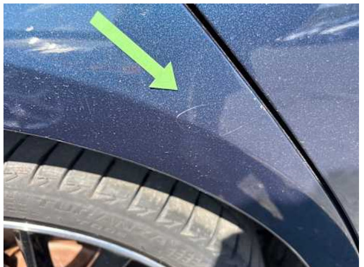
Seitenteil hinten rechts (Kratzer)
