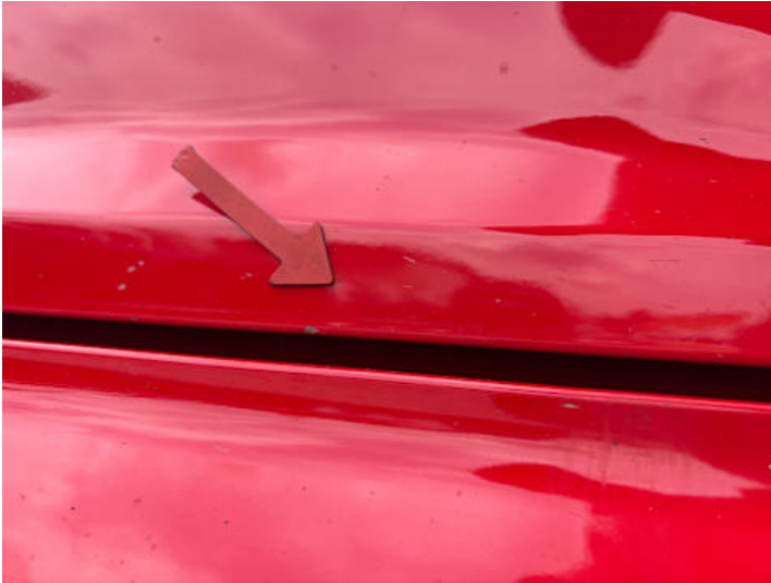
Beifahrertür (Rost, Lackschaden)
