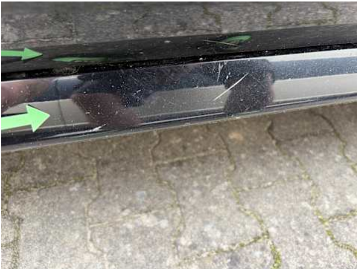
Schweller rechts (Kratzer)
