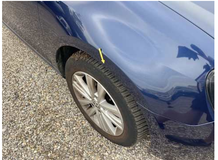
Kotflügel vorne rechts (Rost)
