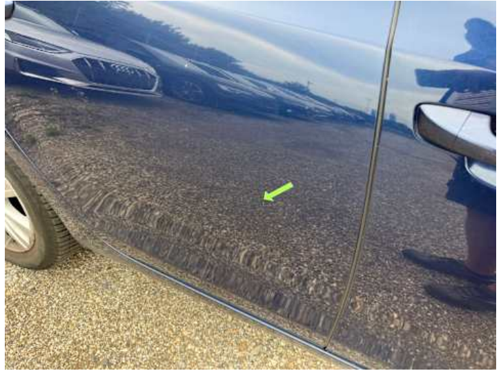
Türe hinten rechts (Lackschaden, Delle)
