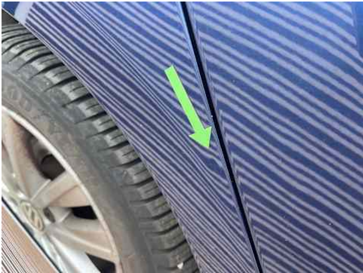
Seitenteil hinten rechts (Delle)
