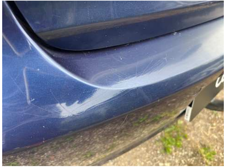
Stoßstange hinten (Lackschaden, Kratzer)
