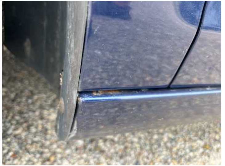
Schweller links (Rost)
