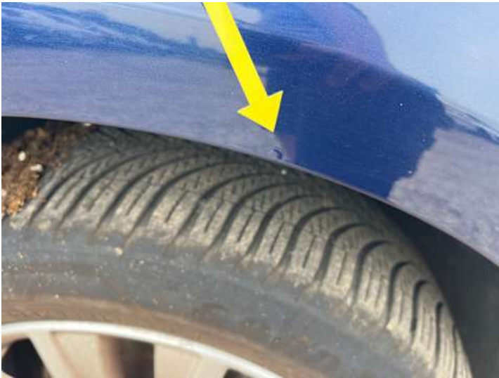
Kotflügel vorne rechts (Rost)
