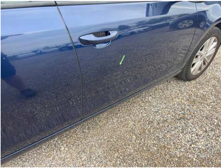
Beifahrertür (Lackschaden, Kratzer)
