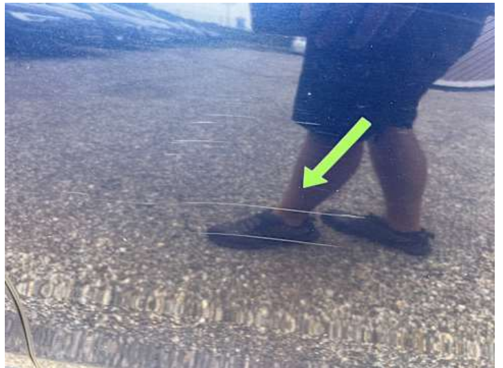
Beifahrtür (Lackschaden, Kratzer)
