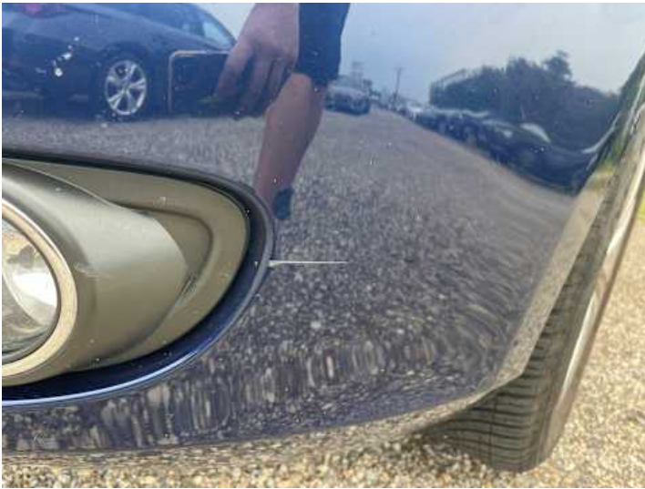
Stoßstange vorne (Lackschaden, Kratzer)
