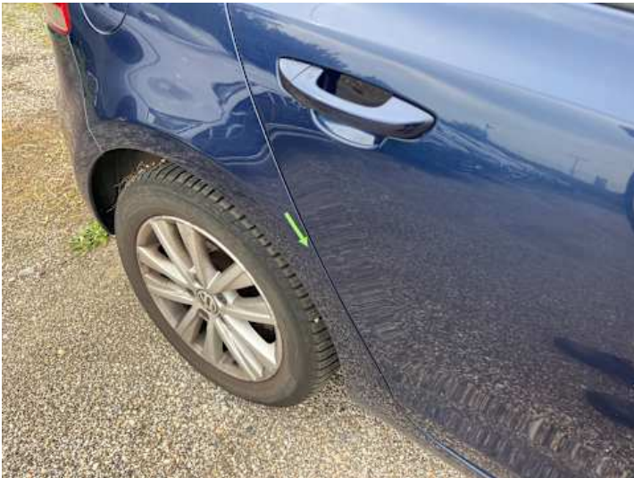
Seitenteil hinten rechts (Delle)
