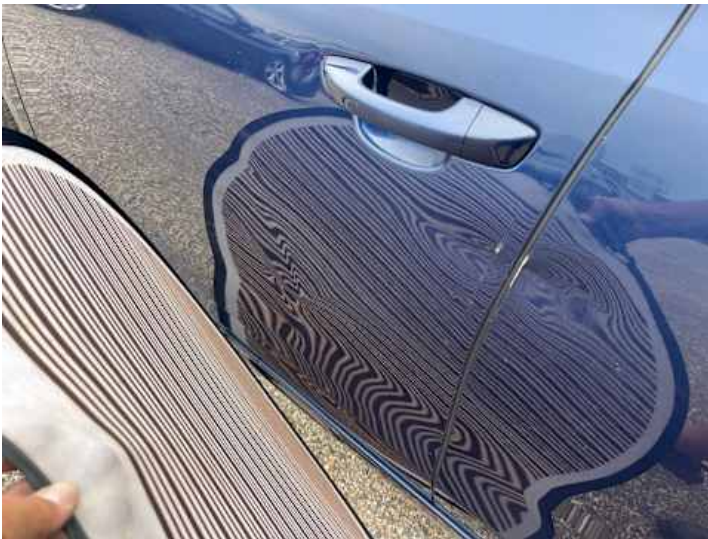
Fahrtür (Lackschaden, Kratzer, Verformung)
