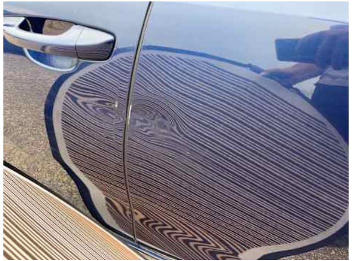
Türe hinten links (Lackschaden, Kratzer, Delle)
