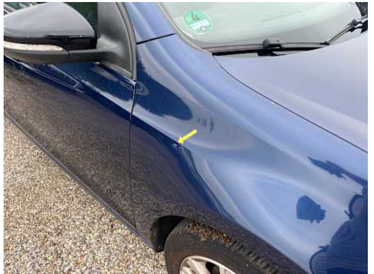
Kotflügel vorne rechts (Lackschaden, Kratzer, Delle)
