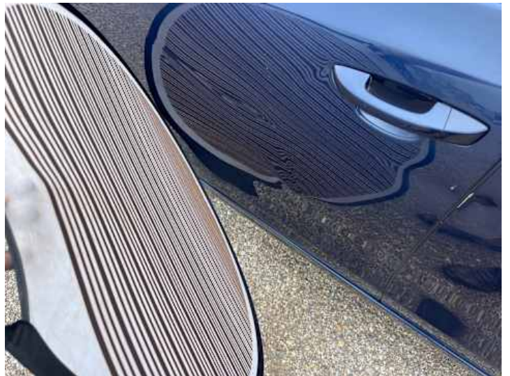
Fahrtür (Lackschaden, Kratzer, Verformung)
