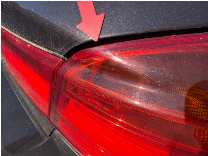
Rücklicht (rechts) (Riss/Bruch)
