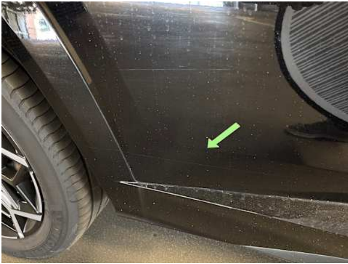
Türe hinten rechts (Kratzer)
