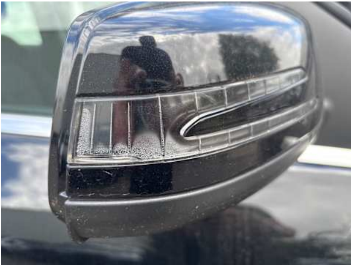
Beifahrertür (Riss/Bruch, Anderer Schaden): Undicht
