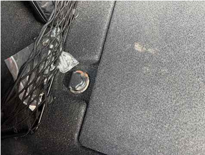
Innenraum (Anderer Schaden): Korrosion
