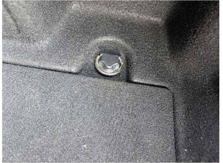
Innenraum (Anderer Schaden): Korrosion
