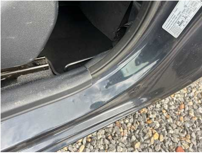
Schweller links (Kratzer, Delle)
