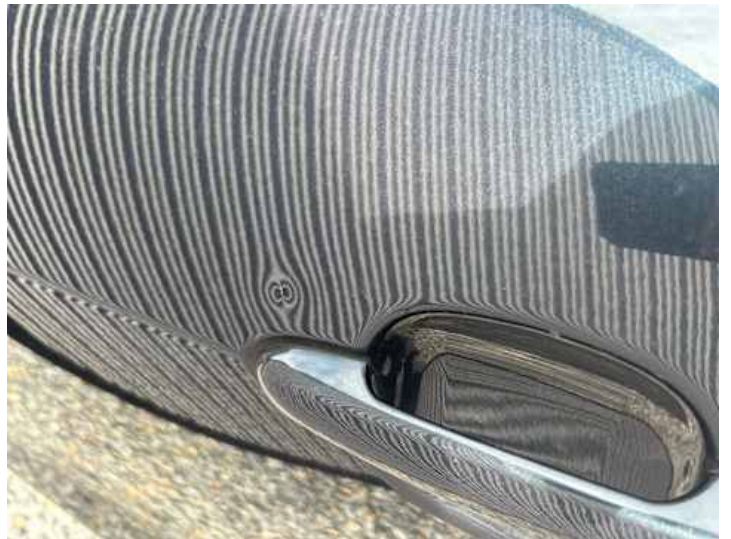
Fahrtür (Kratzer, Delle)
