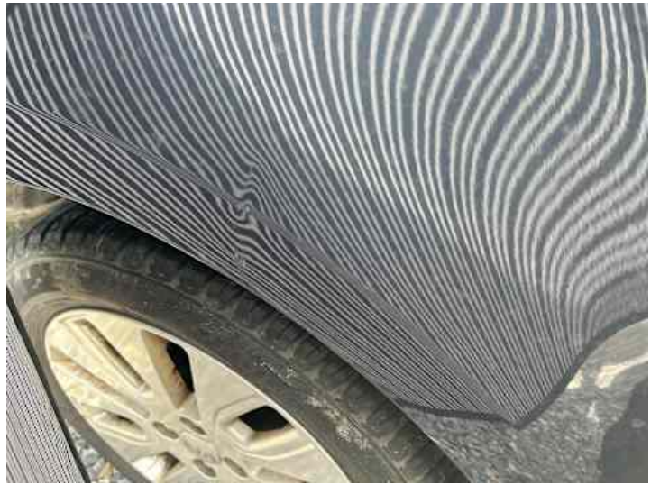
Seitenteil hinten rechts (Verformung)
