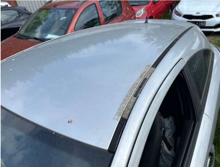
Dach (Kratzer, Unsachgemäß instand gesetzt)
