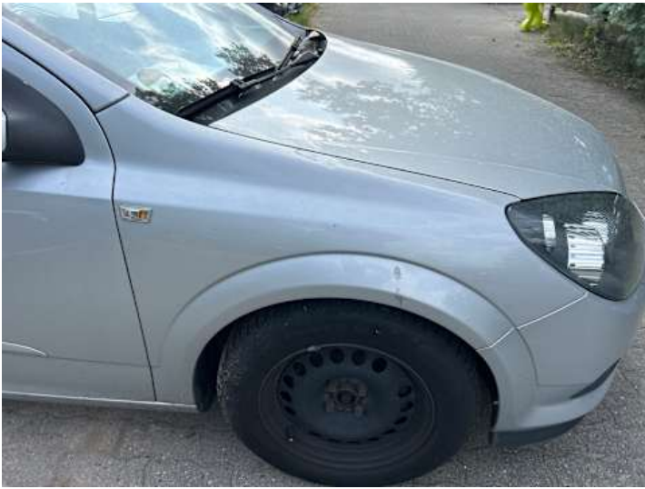
Kotflügel vorne rechts (Kratzer, Delle)
